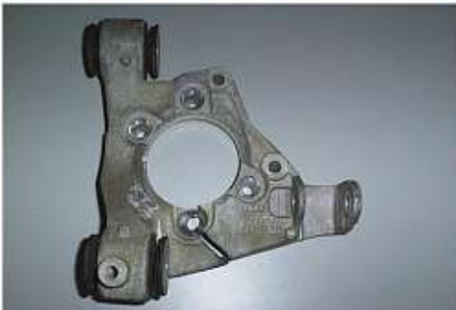
Abbildung 6: Bruch am realen Bauteil
