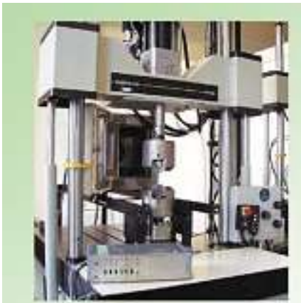
Abb. 2: Servohydraulischer Prüfstand mit 100 kN dynamischer Prüfkraft und Temperaturkammer (Prüftemperatur von -170 bis +600°C),
