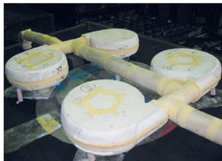
Abb. 14: Aufbau von vier schweren Filterkarussells
