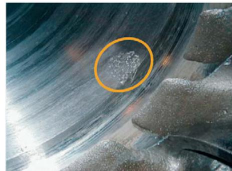
Abb. 12: Filterteile im Gussstück: sichtbar nach Bearbeitung
