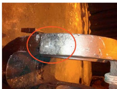
Abb. 27: Oberflächenfehler am Gusstück
