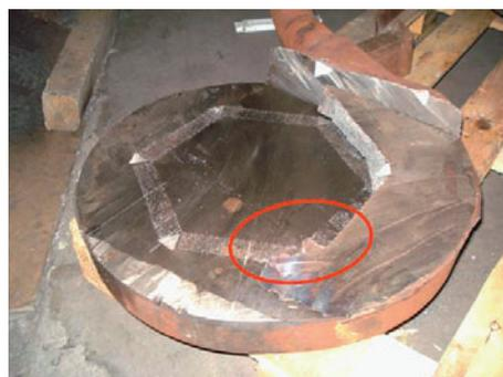
Abb. 15: Fehlendes Eckstück (aufgeschnittenes Filterkarussell nach dem Guss)
