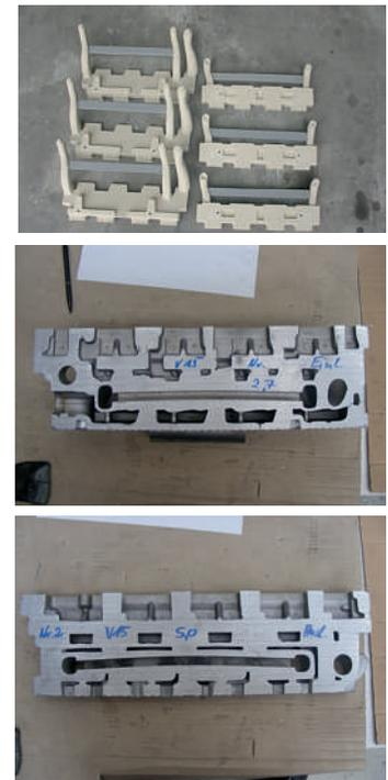
Abb. 15: Deformationsoptimierungen am seriennahen Bauteil
