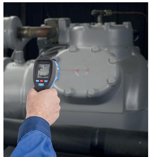
drohen Maschinenausfälle; selbst kleinere Temperaturerhöhungen können zu Schmierstoffproblemen und Lagerschäden führen. Mit dem bedienerfreundlichen Präzisionsthermometer SKF TKTL 40 lassen sich solche Komplikationen verhindern und Temperaturen sicher messen.
