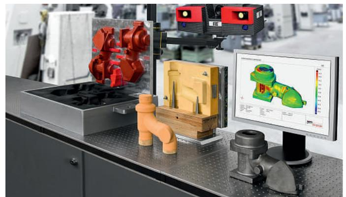
Abb. 3: Die optische Messtechnik unterstützt und beschleunigt fast alle Bereiche vom Modell- & Werkzeugbau, über die Formerei/Kernmacherei bis hin zum Erstmusterbericht und zur Optimierung der CNC-Bearbeitung
