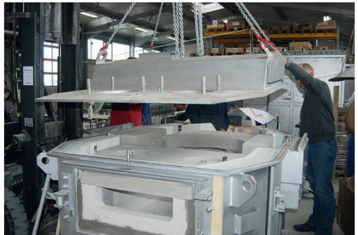
StrikoWestofen bietet jetzt vorkonfektionierte Ofenwannen für Westomat-Dosieröfen unterschiedlicher Baugrößen. Die Wechselteile werden vollständig getrocknet und gesintert angeliefert und reduzieren die Ausfallzeit bei der Neuzustellung von Westomat-Dosieröfen auf nur fünf Tage. Bilder: StrikoWestofen
