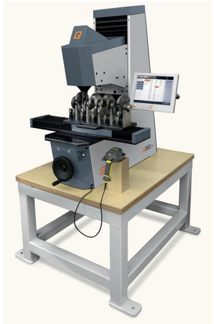
Abb. 3: Zur Komplettierung der Prüfumgebung lieferte Qness die manuelle Prüfmaschine Q250M mit.
