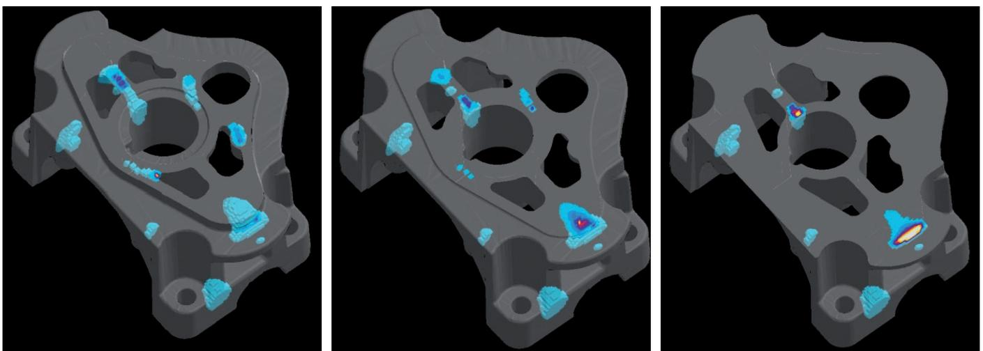
Bild 7: Simulation des Versuchsteils auf Porenbildung in verschiedenen Ebenen des Teils (rot: ca. 50 % Wahrscheinlichkeit für das Auftreten von Poren, gelb: 75-85 % und weiß 100 %).
