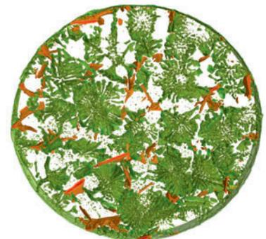
Bild 3: Virtueller CT Schnitt durch eine AlMg5Si7 Legierung (Probendurchmesser ca.  $350 \mu\text{m}$ ). Klar erkennbar sind Mg<sub>2</sub>Si Phasen und Fe-Aluminide (gemessene Dicke bis zu  $0,9 \text{ Mikrometer}$ )
