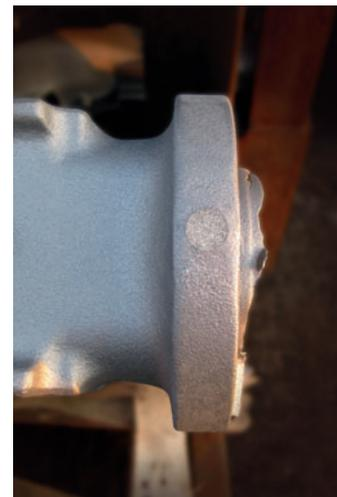
Bild 2: Positionierung eines PX 934 ME20N vor dem Aufformen
