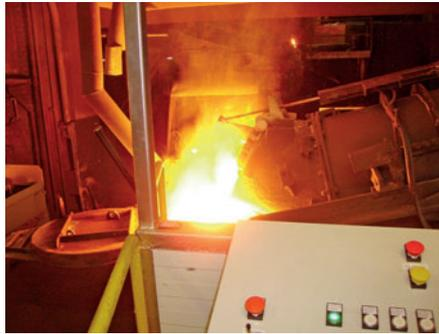
der Behandlung schließen sich die Zugangstüren zur Kammer und die Beobachtungsöffnung automatisch, so dass die Mitarbeiter, die sich jetzt näher am Konverter befinden, kaum mehr durch die Hitze am Arbeitsplatz belastet werden.
