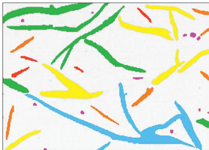
Abb. 4: Mit bisherigen Verfahren erfolgt keine Trennung miteinander verbundener Lamellen. Im Bild ist die untere, hellblaue Struktur ein zusammenhängendes Objekt. Die Lamellengröße ergibt sich aus dem Durchmesser des Umkreises um ein solches Objekt.
