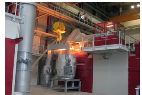
Ausgestellt wird ein 10-t-Ofen, der für eine Nennleistung von 8.000 kW ausgelegt ist. Ferner gestattet die Multi-Frequenztechnik ein Umschalten von 250 auf 125 Hz zum intensiven Einrühren von Legierungselementen und Aufkohlungsmitteln.
