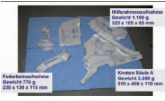
Abb. 14: Beispiele von Prototypenteilen für einen Hochleistungs-Sportwagen
