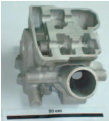
Bild 4: Zylinderkopf aus hochwarmfester Al-Mg<sub>2</sub>Si-Legierung.
