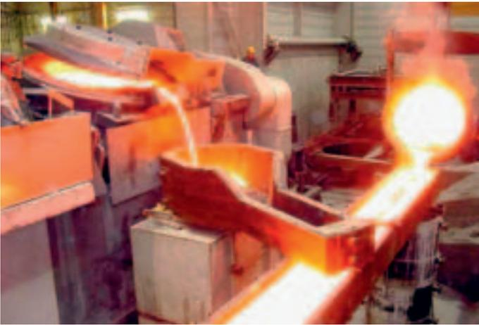
Abb. 3: Abguss eines Schiffspellers gleichzeitig aus 80 t Pfanne und 80 t Induktionsofen
