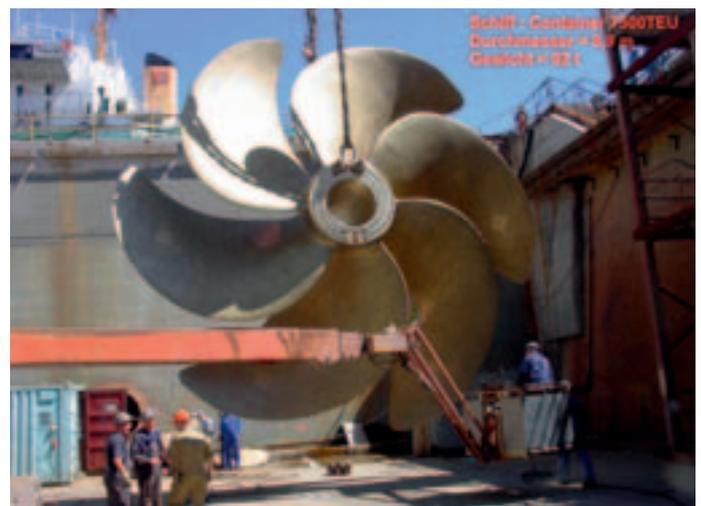
Abb. 2: Schiffspropeller mittlerer Größe mit 8,9 m Durchmesser und 92 Tonnen Gewicht
