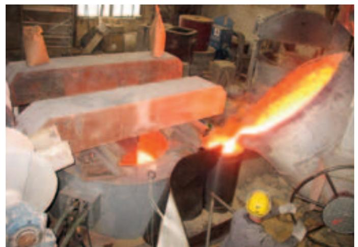
Abb. 8: Abguss eines Versuchskörpers (Propellernabe für einen Verstellpropeller) Magnetfeldeinfluss
