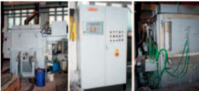
Abb. 16: Schmelz- und Warmhalteöfen mit 300 kg/h Schmelzleistung und 500 kg Warmhaltekapazität als Versuchsträger, links Ofenansicht, Mitte Steuerschrank mit Prozessvisualisierung, rechts Ausschnitt aus der Messtechnik
