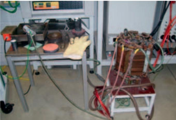
Abb. 4: Ansicht der kleinen Magnetfeldanlage für rotatorische u. transversale Felder am Forschungszentrum Dresden-Rossendorf
