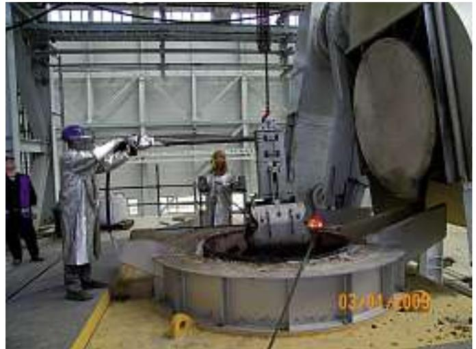
Bild 7: 40-t-Ofen mit geöffneter Absaughaube
