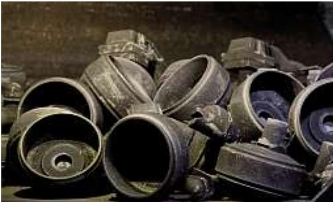
**Bild 1:** Fertige Gussteile in der Produktionslinie bei ACO vor dem abschließenden Entgraten und Sandstrahlen.
