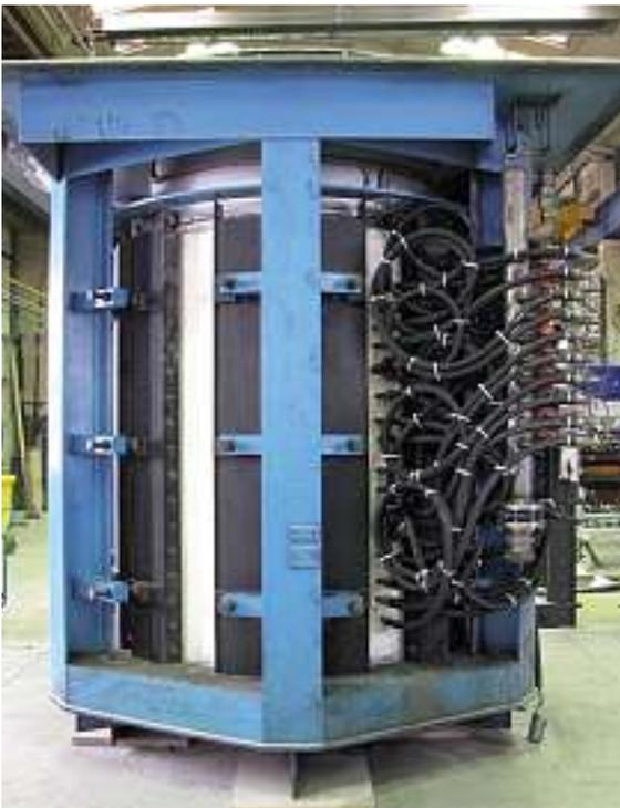
Bild 3: Tiegelofen mit eingebauter Energiesparspule
