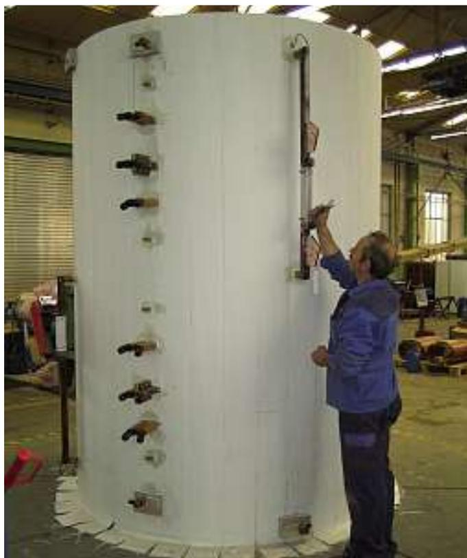
Bild 8: Die Induktionsspule des Aluminium-Ofens in der Fertigung
