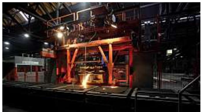
**Bild 3:** Den Gießstrahl und den Füllstand im Eingusstrichter überwachen zwei oben am Gießautomaten installierte, redundant arbeitende intelligente Kameras Simatic VS723; in der Mitte das Dosierrohr zum „Impfen“.
