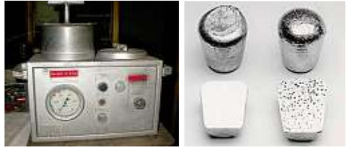
Abb. 3: UD-Gerät und UD-Proben (links: kleiner Gasgehalt, rechts: großer Gasgehalt)
