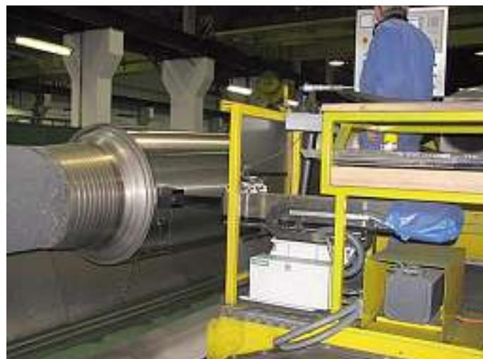
Die Ankopplung der Prüfköpfe an die Walze erfolgt durch einen Wasserspalt. Der Wasserspalt wird mittels einer Dichtlippe erzeugt, das überlaufende Wasser tritt nach oben aus. **Abb. 7** zeigt von der Seite den Prüfarm mit der Anstellung an die Walze und das überlaufende Wasser.
