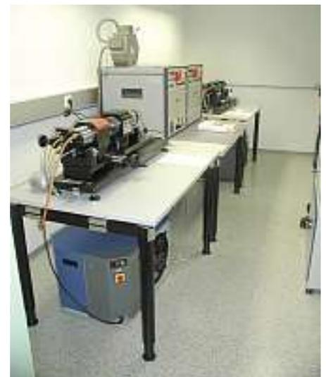
Bild 3: Arbeitsbereich im neu adaptierten Prüfraum mit den beiden Umlaufbiegegeschwingsprüfmaschinen vom Typ „UBM 20Nm“ und den dazugehörigen Aggregaten.
