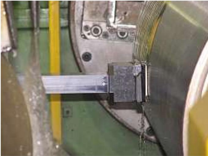
Abb. 7: Seitenansicht des angestellten Prüfkopfes mit Wasserspalt.
