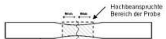
Abb. 8: Hochbeanspruchter Bereich der Probe, der bei der Auswertung berücksichtigt wurde.
