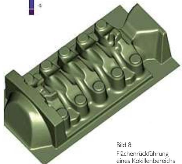
Bild 8: Flächenrückführung eines Kokillenbereichs
