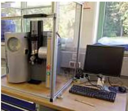
Bild 1: Neue optoelektronische berührungslose Probenmessanlage mit Gerätetisch, Staubschutz und PC-Anbindung. Eine Probe ist eingespannt und im Projektorfeld sichtbar.
