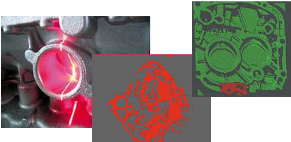
Abb. 5: Oberflächen Erfassung durch Lasertriangulation
