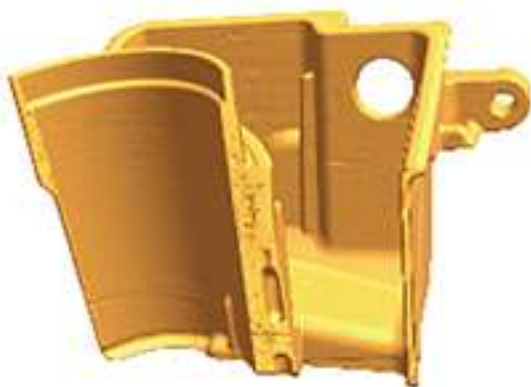
Abb. 15: Dreidimensionaler Schnitt durch das Druckgussgehäuse im Bereich des größten Volumendefizits
