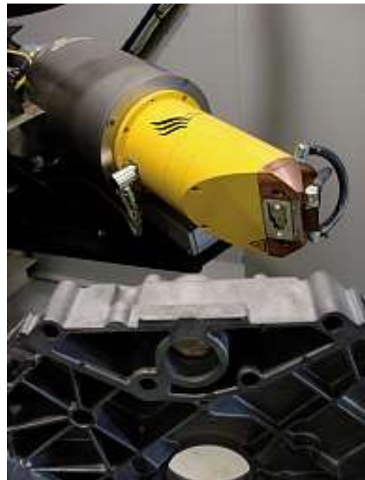
Bild 4: Die offene 225 kV Mikrofocus-Röntgenröhre erlaubt hochauflösende Röntgeninspektion bei praktisch unbegrenzter Röhren-Lebensdauer.
