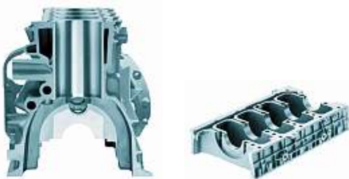
Bild 9: Al-MMC-Technologie: optional ist eine 360°-Hauptlagerstärkung sowohl im Zylinderkurbelgehäuse als auch im Bedplate möglich
