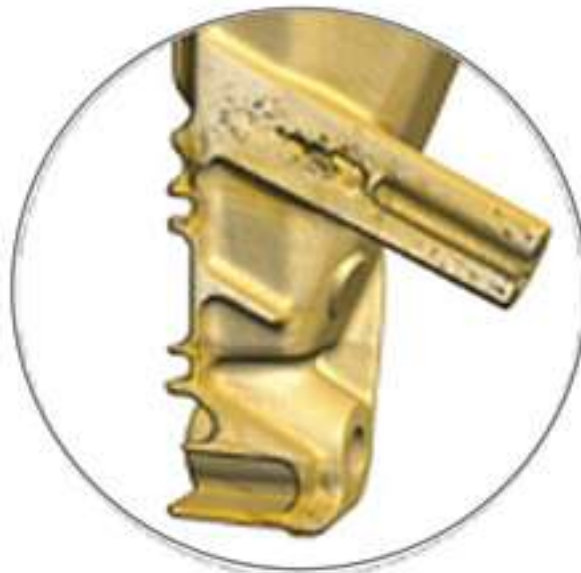
Abb. 16: Volumendefizit im Bereich der Bohrung
