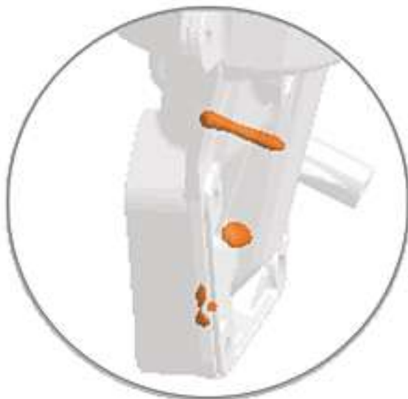
Abb. 14: Simulation eines flüssigen Bereichs bei 90 % Erstarrung
