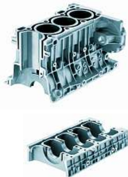
Bild 2: Zweiteiliges LOKASIL®-Zylinderkurbelgehäuse mit herkömmlichem Open-deck und dem dazugehörigen Bedplate mit MMC-Hauptlagerverstärkung
