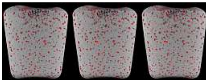
Abb. 6: Vergleich der unterschiedlichen Porendetektionen in Abhängigkeit der Parameterwahl
