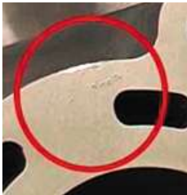
Abb 1: Oberflächenfehler an bearbeiteter Gussteilfläche
