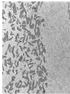
Schnitt und Gefüge durch die LOKASIL®-Lauffläche
