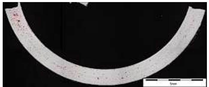
Abb. 9: Darstellung der am Schliiff detektierten Gesamtflächenporosität
