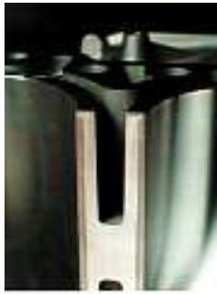
Schnitt und Gefüge durch die LOKASIL®-Lauffläche
