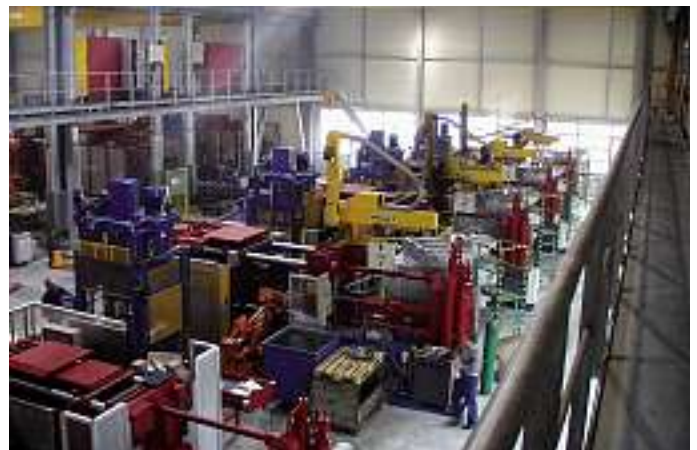
Bild 2: Die 21 Gießzellen am DGH-Standort Dohna verfügen über eine Jahreskapazität von 9.000 t Aluminium.
