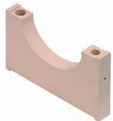
Bild 7: MMC-Schnittstück aus einer Lagerbrücke mit einer eingegossenen Preform im Druckguss
