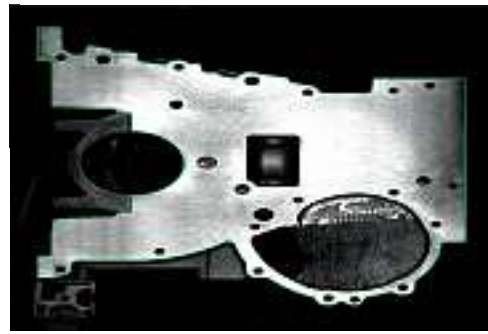
Abb. 8: Verfolgung der Umrisse zur Erkennung von Formfehlern
