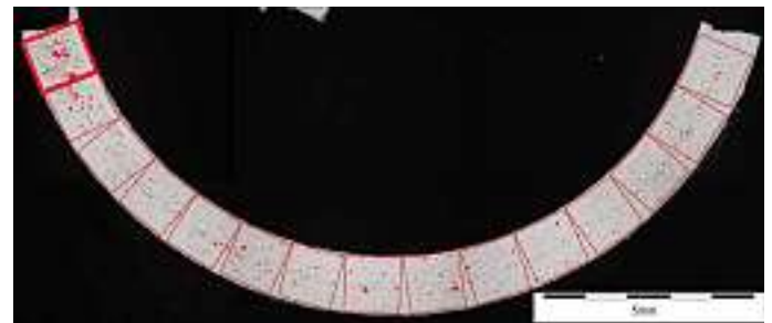
Abb. 10: Darstellung der am Schliiff detektierten Flächenporosität nach VDG-Merkblatt P201 samt Markierung des ROI mit maximaler Porosität
