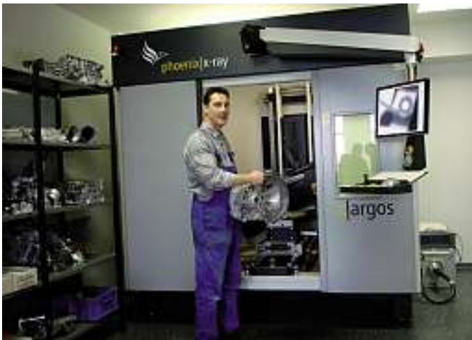
Bild 3: Kompaktes Inspektionssystem mit Schwenkarm: QW-Mitarbeiter Maik Hübner legt ein Kupplungs- und Getriebegehäuse in den x|argos ein.
