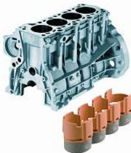
Bild 1: Einteiliges Zylinderkurbelgehäuse in Schürzenbauweise mit den innovativen Technologien LOKASIL®, Closed-deck und MMC-Hauptlagerverstärkung
