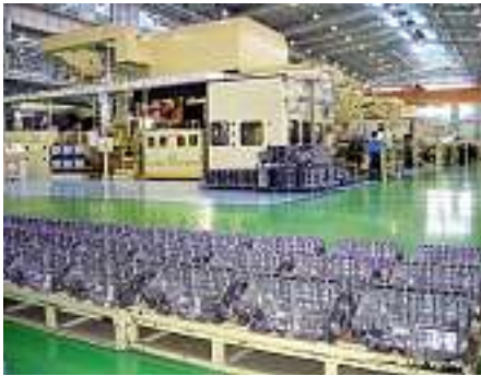
Die neuen Bühler-Druckgiessanlagen in der alten Eisengiesserei von Hyundai in Ulsan
