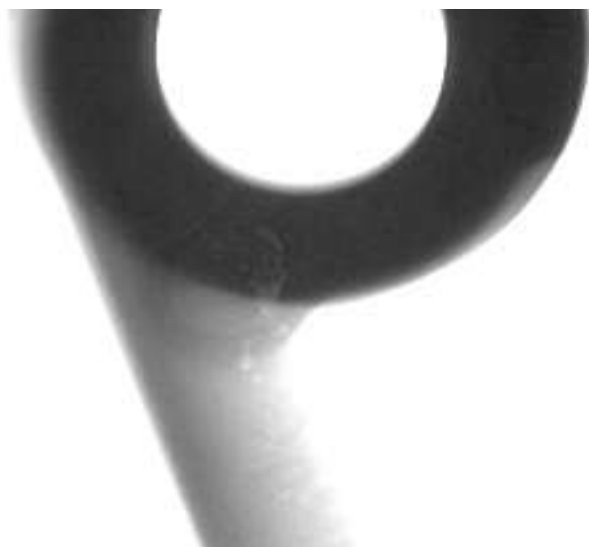
Abb. 3: Hochauflösende Radioskopie eines Kokillengussteils
