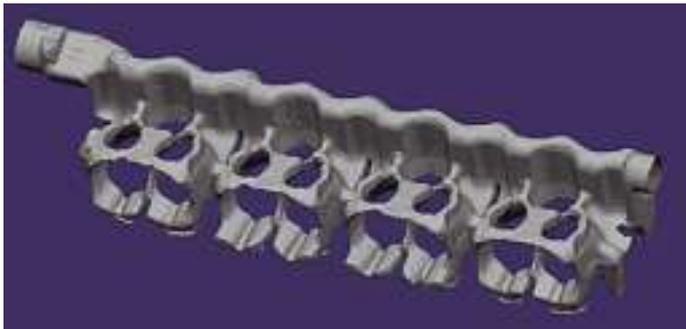
Bild 3: Aus 3D-CT Daten erstelltes Oberflächenmodell des Wassermantels eines PKW-Zylinderkopfs
