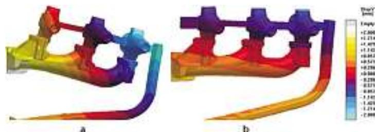
Bild 3: Bauteilverzug vor (a) und nach (b) der Optimierung der Laufgeometrien. Die Variation von Stegbreiten des Laufes zwischen den einzelnen Speisern führt zu unterschiedlicher Steifigkeit und Schwindungsbehinderung des Bauteils. Hierdurch konnte der Verzug des Krümmers deutlich reduziert werden.
