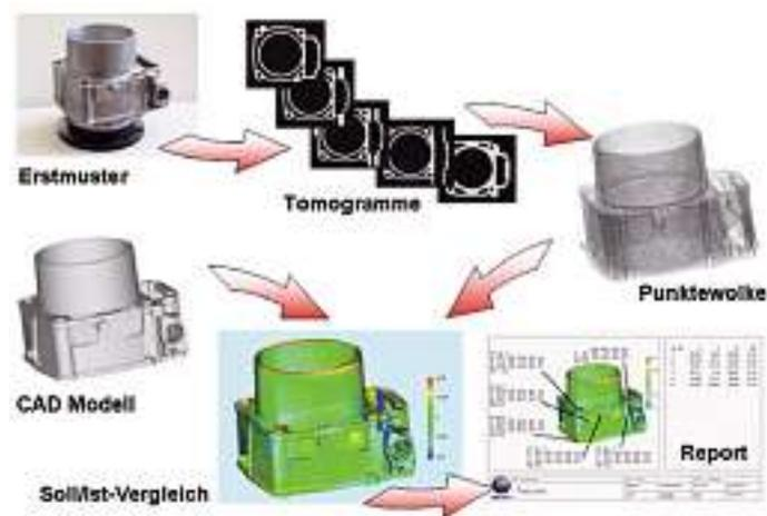
Bild 2: Prozesskette Erstmusterprüfung
