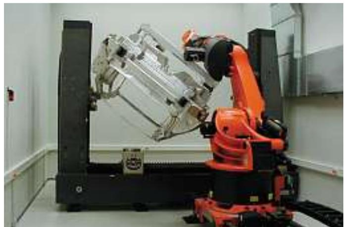
Abb. 1: CT-Anlage der AUDI AG in Neckarsulm mit Handlingeinrichtung und Karosseriestruktur des Audi A8
