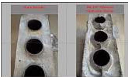
Bild 6: 4-Zylinder-AL-Motorblock-Abgüsse mit unterschiedlicher Speiseranordnung nach Bild 4
