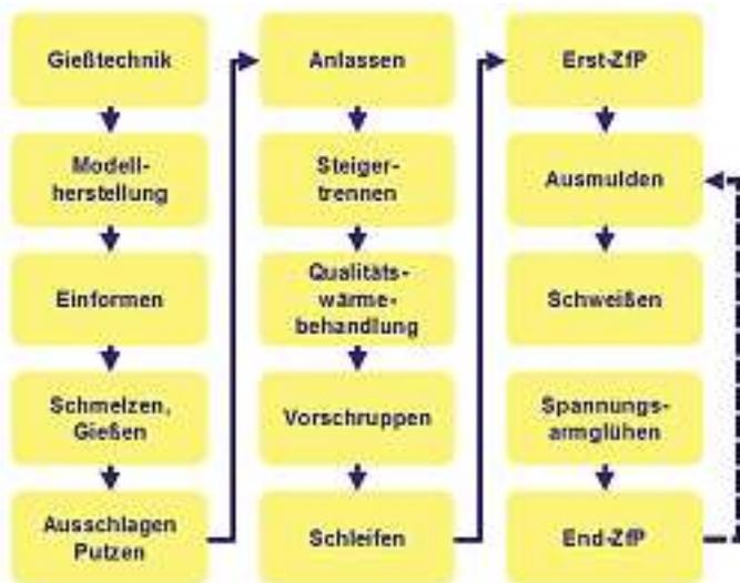
Abbildung 3: Typischer Fertigungsplan für schwere Stahlgussstücke
