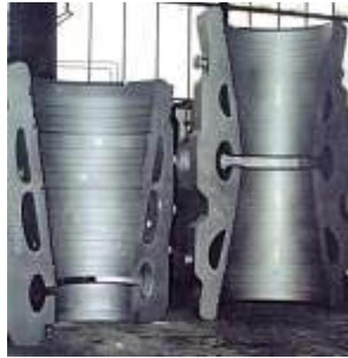
Abbildung 10: MD Innengehäuse: Schkopau, 14 t und Meri Pori, 19 t (G-X12CrMoWVNbN10-I-1)
