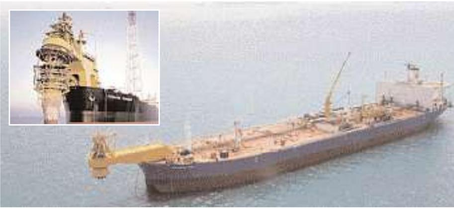
Bild 2: Das Kardangeln der voestalpine Gießerei Linz ist Teil der gelben Stahlkonstruktion (a) am Bug eines FPSO-Schiffes (b), damit sich dieses um die eigene Achse drehen kann.
