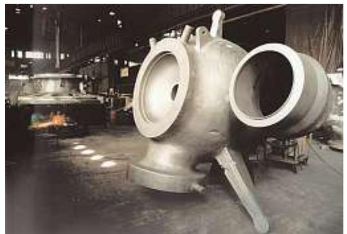
Abbildung 13: Ventilgehäuse mit 27 t (G-X12CrMoWVNbN10-I-1) für das KW Lippendorf
