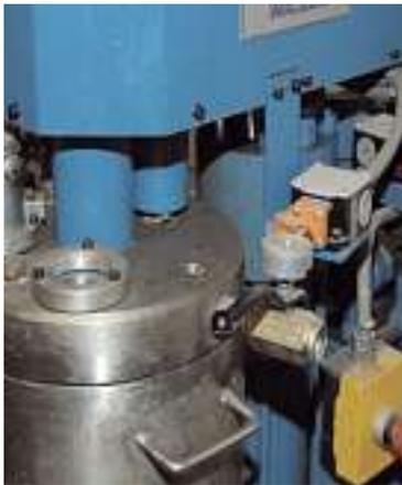
Bild 3: Der halbtechnische Molteni-Dissolver
