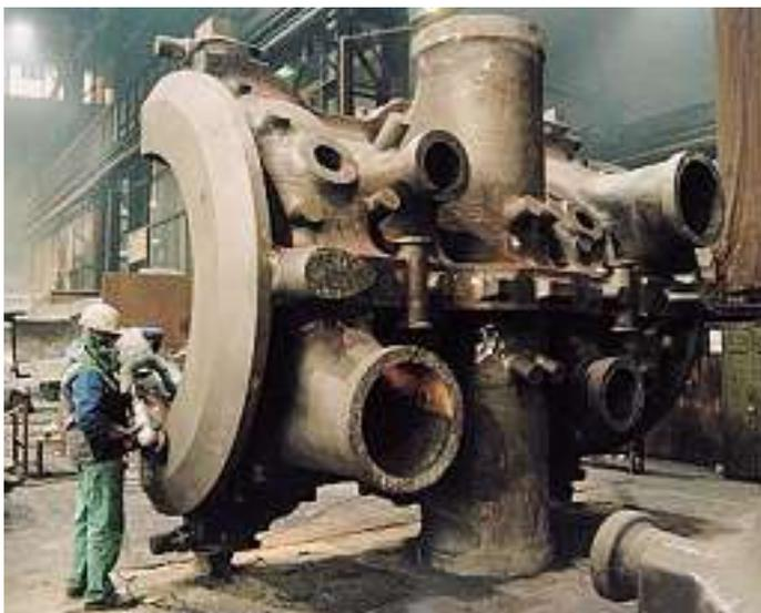
Abbildung 14: Boxberg, MD Innengehäuse 60 t (G-X12CrMoWVNbN10-I-1)
