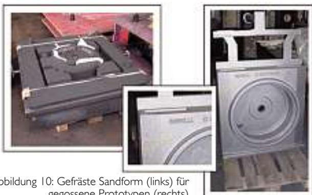
Abbildung 10: Gefräste Sandform (links) für gegossene Prototypen (rechts)
