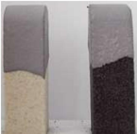
Bild 7: Farbe der Schlichte „Hydro A 65“ auf einem Cold-Box-Kern (links) und auf einem Furanharz-Kern (rechts).
