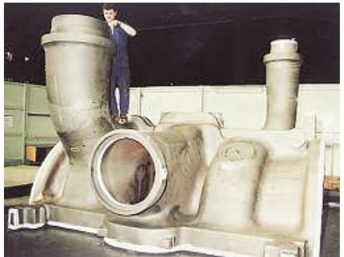
Abbildung 11: Schwarze Pumpe, MD Innengehäuse, 40t mit angeschweißten, gegossenen Krümmern (G-X12CrMoWVNbN10-I-1)
