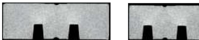
Bild 5: CT-Schnitte (Längs- und Querrichtung): Form mit Verdichtung von oben
