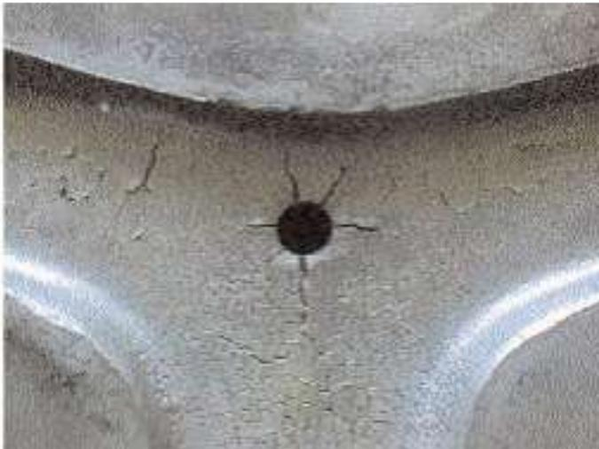
Abb. 4: Brandrissnetzwerk an einer Formoberfläche
