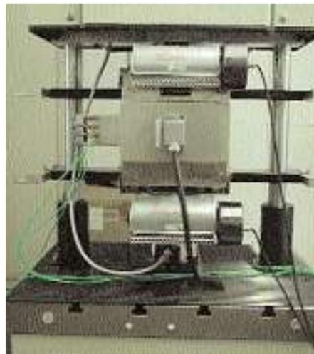
Bild 3: 20 kN-Resonanzfrequenzmaschine RUMUL mit Temperierofen.
