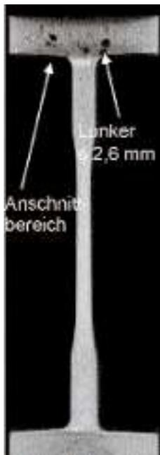
Abb. 19: Axialer, virtueller 2-D-Schnitt
