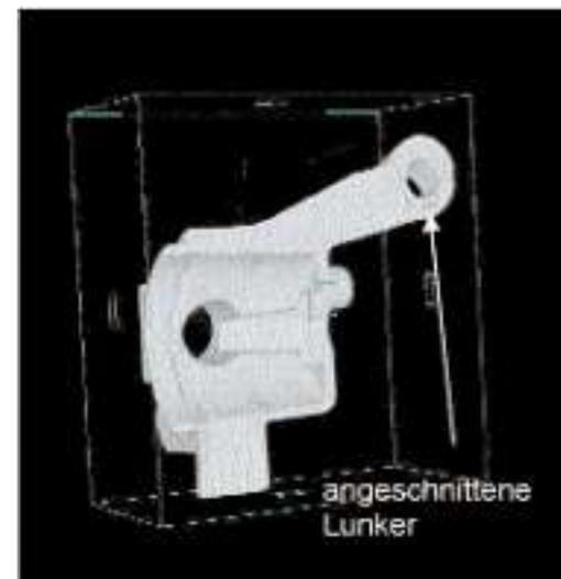
Abb. 8: Virtueller 3-D-Schnitt durch das Bauteil
