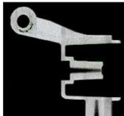
Abb. 13: Darstellung der Flächenporosität von 2,5 % im virtuellen, sagittalen Schnitt
