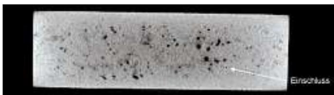
Abb. 28: Virtueller 2-D-Schnitt von Segment 2
