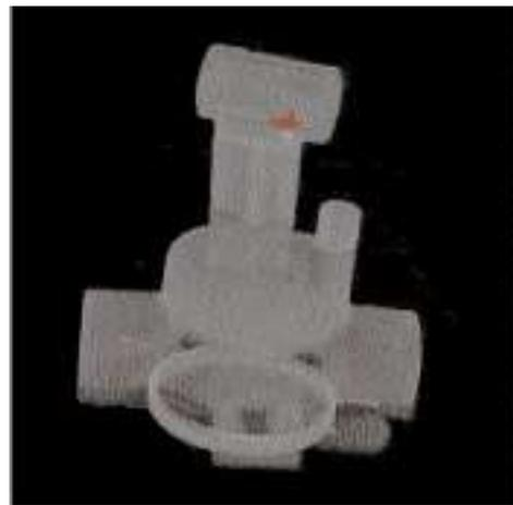
Abb. 12: 3-D-Darstellung eines Lunkers (halbtransparentes Bauteil)
