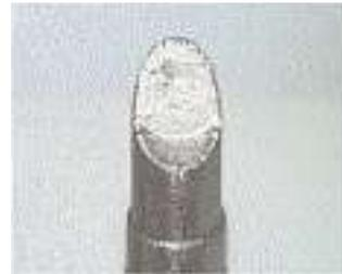
Abb. 17: Stahl-Pinole im Messingdruckguss nach 7.000 Abgüssen.
