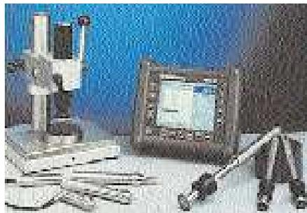
Diese TIV-Messtechnik zeichnet sich aber auch bei der Härteprüfung in Härtereien und Unternehmen aus, die sich mit der Wärmebehandlung von verschiedenen Materialien ohne Kalibrierung befassen.
