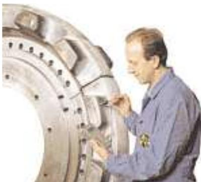
Beim Rückprallverfahren erzeugt ein Schlagkörper mit definierter Geschwindigkeit beim Aufprall eine plastische Verformung der Oberfläche des Prüfobjektes. Der Schlagkörper verliert dabei einen Teil seiner ursprünglichen Geschwindigkeit bzw. Energie.
