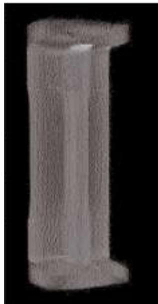
Abb. 17: 3-D-Darstellung von Lunker (halbtransparentes Bauteil)
