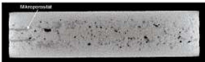
Abb. 27: Virtueller 2-D-Schnitt von Segment 1
