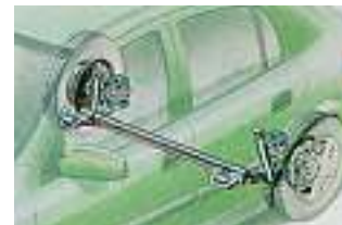
Bild 19: Einsatz von Schweißtechniken zur Verbindung von Sphäroguss mit Stahl a) Beispiel Verbundlenkerachse
