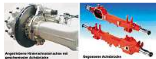
Bild 20: Substitutionspotenzial von Schweißkonstruktionen und Stahlschmiedeteilen bei Nutzfahrzeugen [6] a) geschweißte und gegossene Achsbrücke
