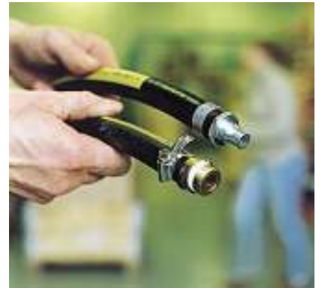
Abb. 2: Gegenüber der allenthalben gebräuchlichen, verletzungsträchtigen Schraubklemme besticht die hydraulisch aufgepresste Ringklemme oben als saubere Lösung.
