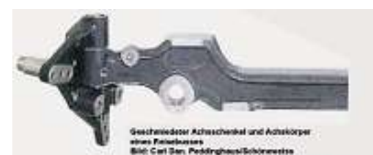
b) geschmiedete Achsschenkel und Achskörper eines Reisebusses [6]
