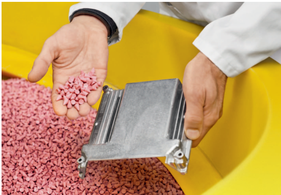
Abb. 1: Bearbeiten von Druckgussteilen in einem Rundvibrator CB 400 von Walther Trowal.
