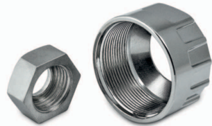
Abb. 10: Klemmring mit gegossenem Innengewinde als Überwurfmutter für Kabelverschraubungen. Mittels drehender Entformung kann das Teil ohne mechanische Nachbearbeitung mit hoher Wirtschaftlichkeit gefertigt werden. Durch die Umstellung auf Zinkdruckguss wurde ein Kostenersparnis von bis zu 35 Prozent erzielt [6].
