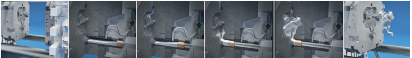
Abb. 3: Ein in die Druckgießmaschine integriertes Vakuumsystem erhöht die Anlagenverfügbarkeit und vereinfacht die Bedienung.
