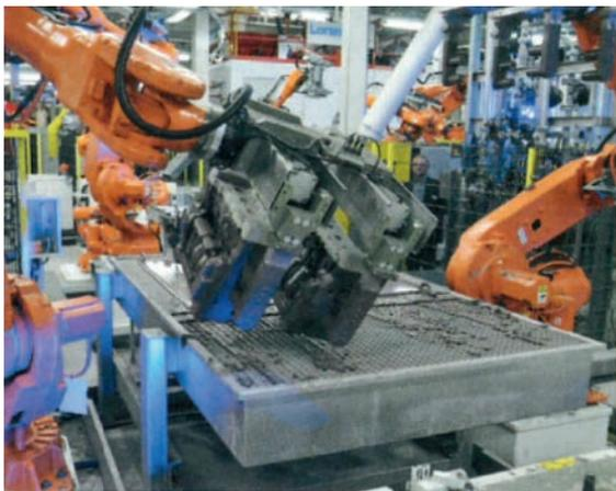
Zylinderkurbelgehäuse neuer Euro6-Motorengenerationen durch den Einsatz von Robotern prozesssicher zu produzieren. Mit einer manuellen Montage könnte diese hohe Präzision nicht erreicht werden.
