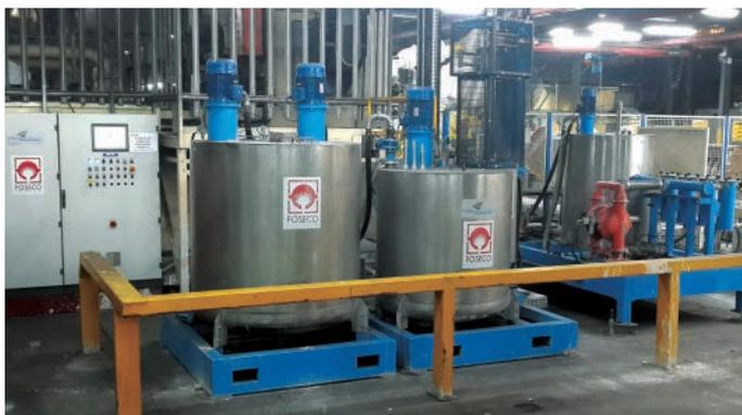
Abb. 5: Rechts: Bedienfeld, Lager- und Schlichteaufbreitungstank
