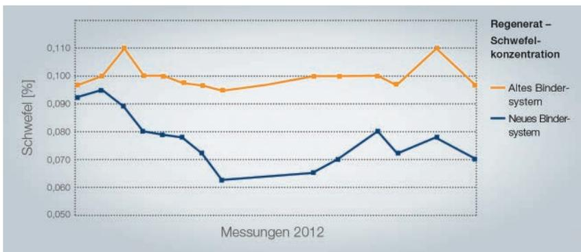
Abb. 4: Die Absenkung des Schwefelgehalts im Regenerat trägt zur Sicherung einer guten Gussqualität bei.
