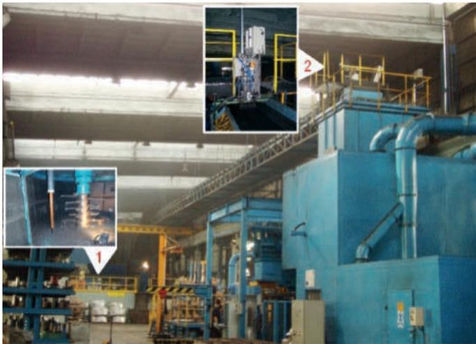
Abb. 2: Charakteristische verfahrenstechnische Anordnung der modularen Mess- und Prüfsysteme des Formsand-Management-Systems FoMaSys am Beispiel einer Sandaufbereitung in Polen.
