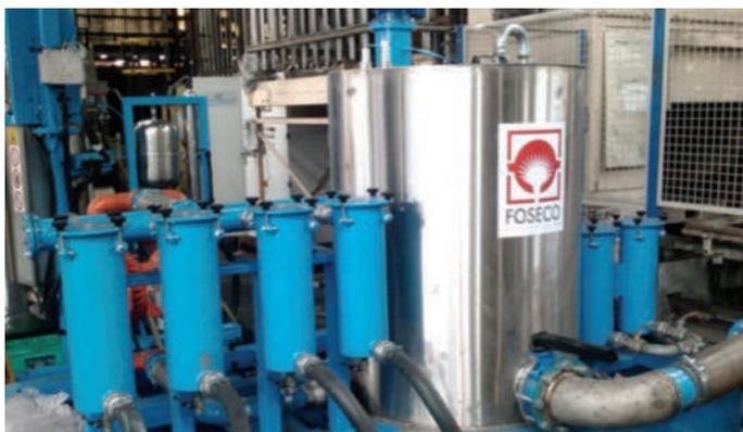
Abb. 4: Zwischentank und Filter
