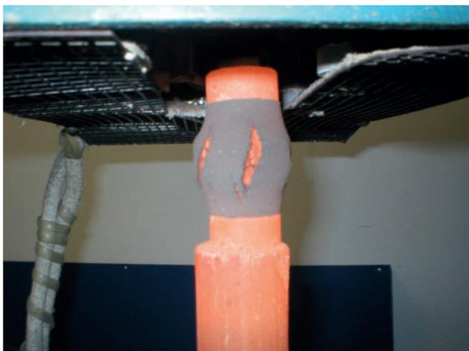
Abb. 4: Heißdruckfestigkeitsmessung, plastische Verformung bei 820°C
