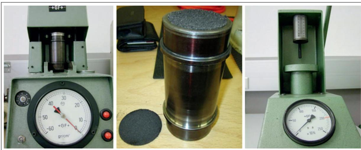
Abb. 5: Gerät zur Nasszugprüfung mit Probe (links/Mitte) und Verdichtungsprüfung (rechts)
