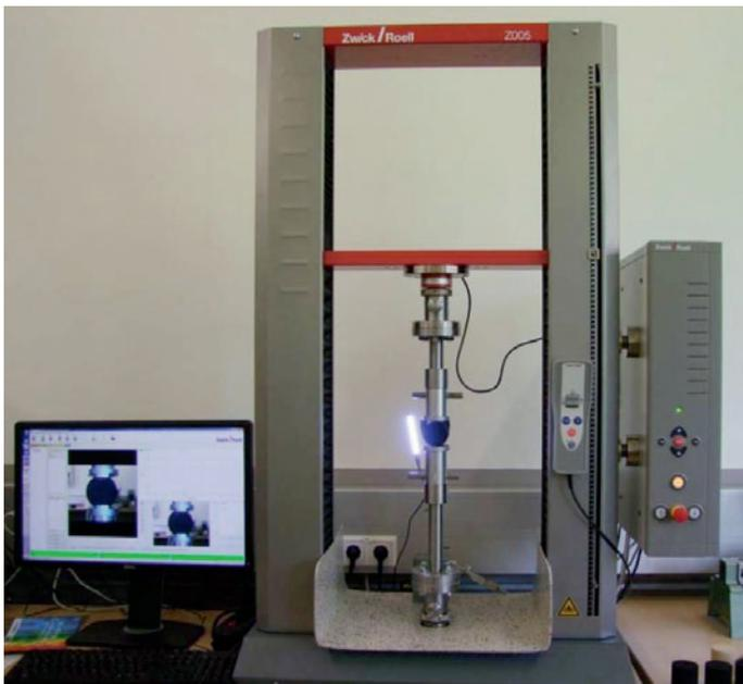
Abb. 6: Formstoffprüfmaschine Fa. Zwick, Nennlast 5 kN, Bezeichnung Z005 proline
