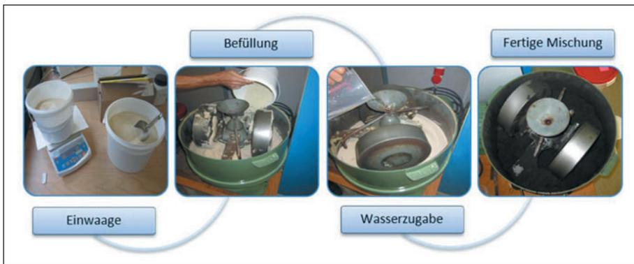
Abb. 10: Herstellung der Formstoffmischung im Laborkollergang
