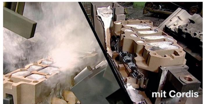
Bild 2: Emissionsvergleich Cold-Box vs. Cordis
