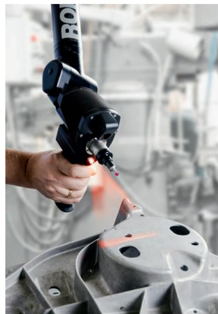
ROMER Absolute Arm mit integriertem Laserscanner
