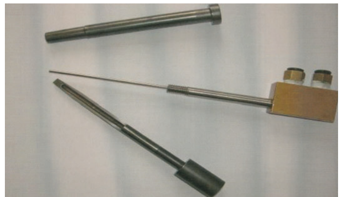
Bild 2: Der geöffnete Kern zeigt die Bohrung für das JetCooling-Strahlröhrchen sowie den gesamten Kern oben
