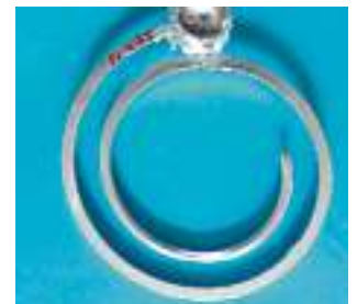
Bild 1: Versuchswerkzeug – Spiralkokille (links), Spiralprobe (rechts)
