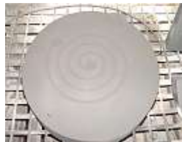
Bild 1: Versuchswerkzeug – Spiralkokille (links), Spiralprobe (rechts)
