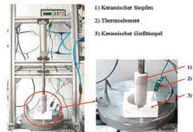
Bild 3: Versuchseinrichtung mit Dosiersystem
