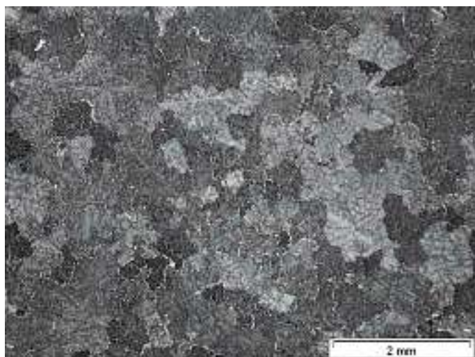
Bild 4a. Mikrostruktur vor der Kornfeinung bei einer Schmelztemperatur von 750 °C.
