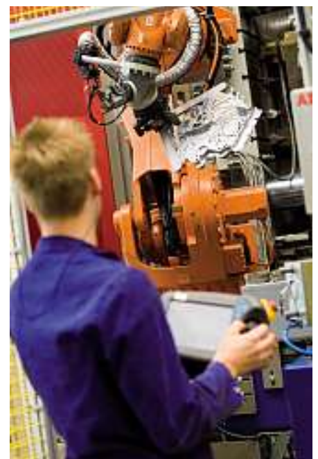
Bild 3: Im Zuge der Verlagerung wurden zwölf zusätzliche vollautomatische Gießzellen mit Roboterinstallation aufgebaut.
