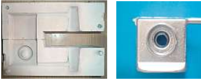
Bild 2: Versuchswerkzeug – Kugelschmelzkocher (links), Kugelprobe (rechts).
