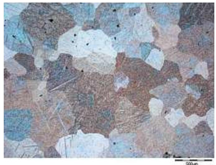
Abb. 9: Gefüge nach 2 min. Haltezeit und Zugabe von  $0,17 \text{ Gew. } \%$  Zr zur Mg Schmelze
