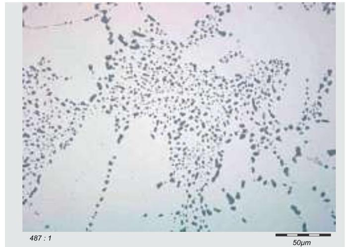
Abb. 15: Schlibbild 16 mm Stufe nach 3,5 Stunden Glühzeit
