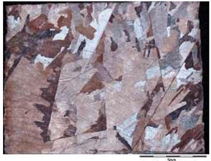
Abb. 8: Gefüge des nicht korngefeinten Mg im angelieferten Zustand
