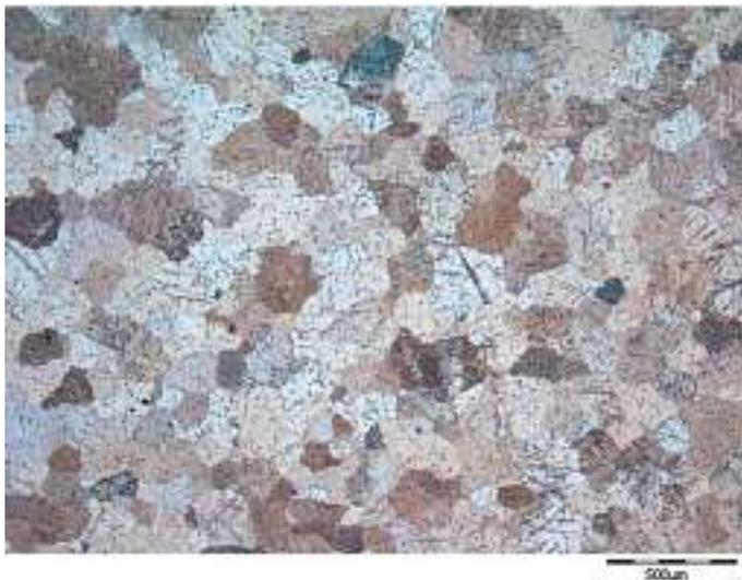
Abb. 10: Gefüge nach 2 min. Haltezeit und Zugabe von 0,25 Gew. % Zr zur Mg Schmelze
