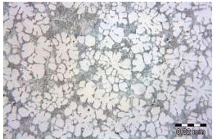
Bild 2: Gefüge von MAXXALLOY®-Ultra®, Druckguss, Wanddicke 2,6 mm
