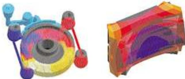
Bild 3: Verteilung der Schmelze aus unterschiedlichen Anschnitten während der Formfüllung
