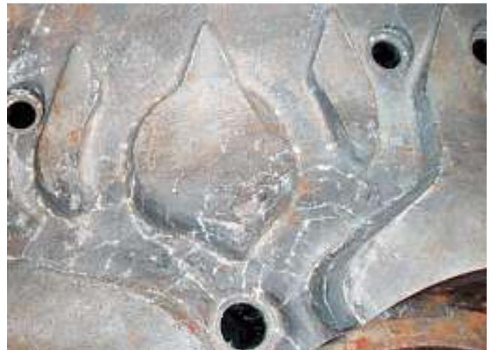
Abb. 1: Brandrissnetzwerk an der Oberfläche eines Druckgusswerkzeuges nach ca. 110.000 Zyklen.
