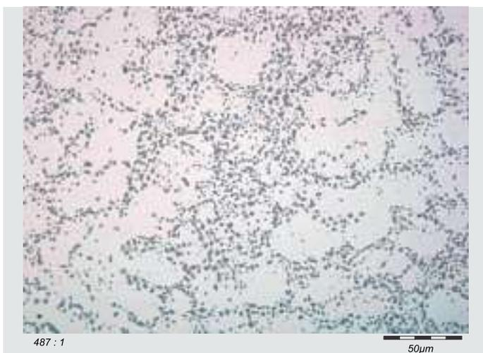
Abb. 14: Schlibbild 4 mm Stufe nach 2 Stunden Glühzeit
