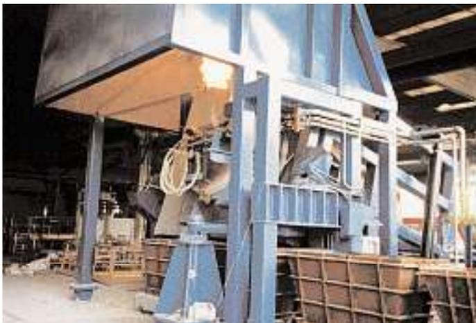
Abb. 14: Kippbarer 14t Drehtrommelofen mit Erdgas/Sauerstoffbrenner
