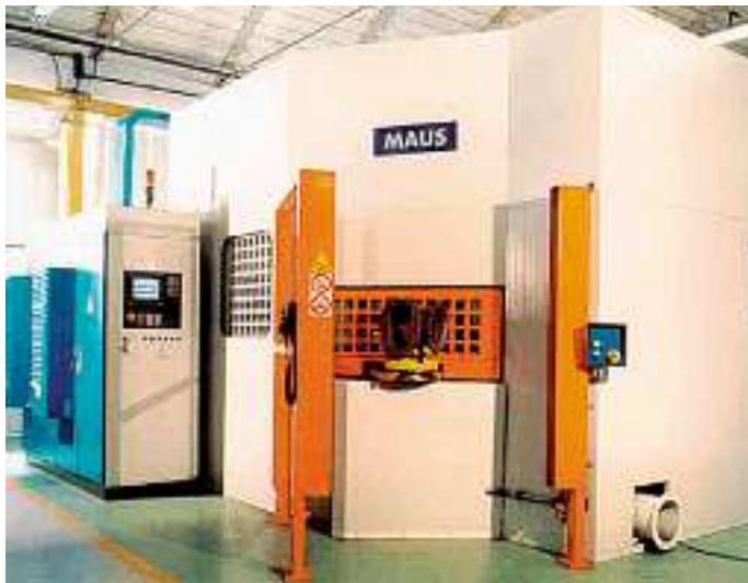
Bild 2: Automatische Gussputzmaschine der Fa. Maus Spa.
