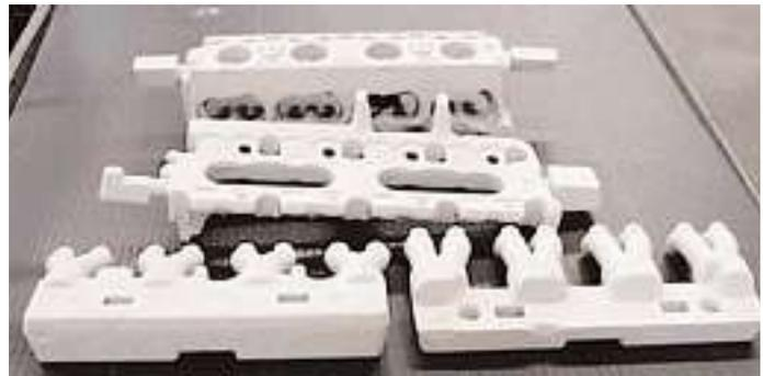
Bild 5: Kerne für einen „anorganischen“ Zylinderkopf
