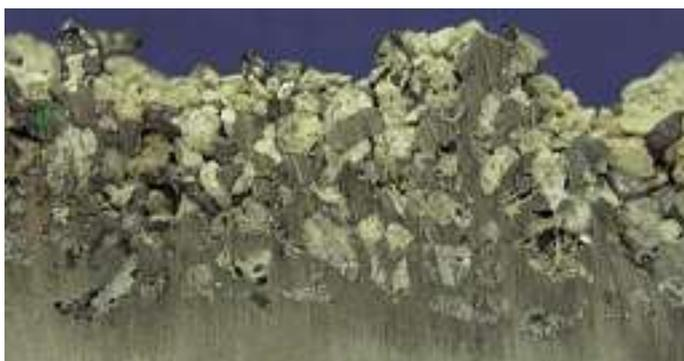
Bild 12: Porenbaustoff (M = 1:1) – Flüssigeisen dringt 30 mm ein!
