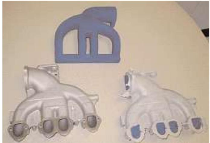
Bild 4: Cordis-Kern, abgegossener Cordis-Kern, Cordis-Gussstück
