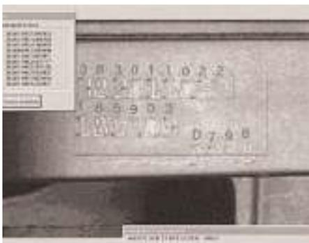
Bild 2: Die seitlich am Integralträger eingeritzten Guss- und Teiledaten werden vom Bildverarbeitungssystem automatisch gelesen und ausgewertet. Innerhalb des blauen Fangrahmens erkennt die Software die geritzten Zeichen und vergleicht sie mit den Soll-Daten.
