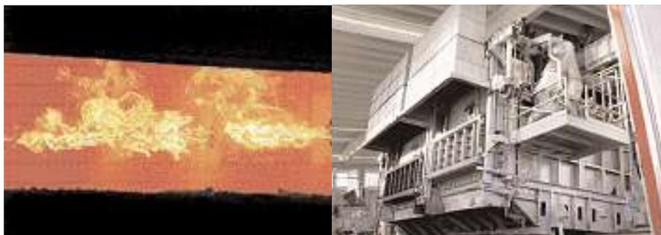
Abb. 17: Beispiel eines Zwei-Kammer- und eines Side-Well-Herdofens ausgestattet mit Sauerstoff-Brennern
