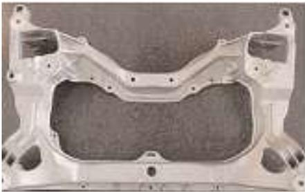
Bild 1: Der Entstehungsprozess des gegossenen Integralträgers ist in einem 15-stelligen Identcode (im Bild nicht sichtbar) eindeutig nachvollziehbar.
