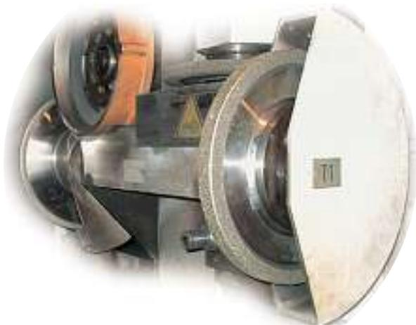
Bild 4: Bearbeitungssystem Focur SA zum automatischen Gussputzen bei Montella.
