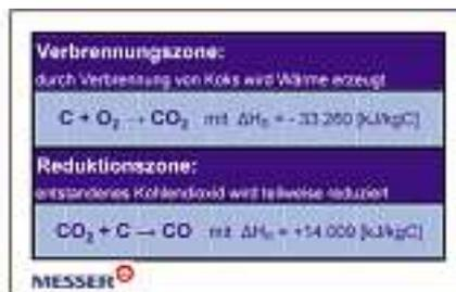
Abb. 8: Reaktionen in Verbrennungs- und Reduktionszone.
