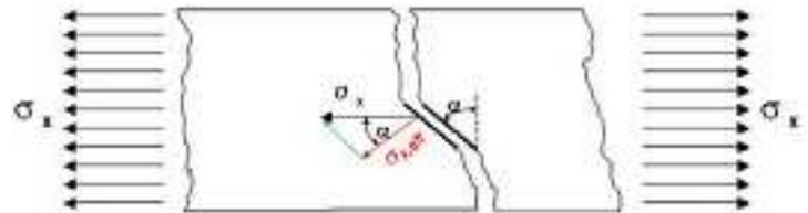
Abb. 7: Berechnung der rissöffnenden Spannung
