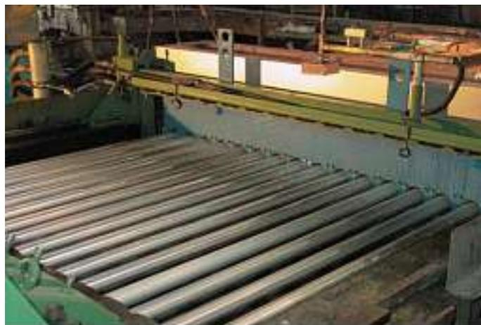
Abb. 4: Horizontal-Stranggussmaschine.
