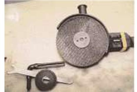
Durch den für einen Elektroschleifer ungewohnt kleinen Winkelkopf können die Schleif- u. Trennscheiben bis zu 90 % abgenutzt werden. Ein Scheibenwechsel ist erst notwendig, wenn die 180er Scheibe soweit verbraucht ist, wie hier unten im Bild ersichtlich.
