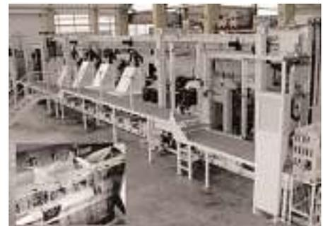
Bearbeitungsanlage für Daimler Chrysler Türscharniere (6 Mio Teile/Jahr, Taktzeit 2,75 sec, 34 NC-Achsen, 52 Bearbeitungsspindeln, 600 KW Anschlussleistung)
