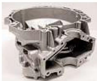
Kupplungsgehäuse für 6-Gang-Getriebe.
