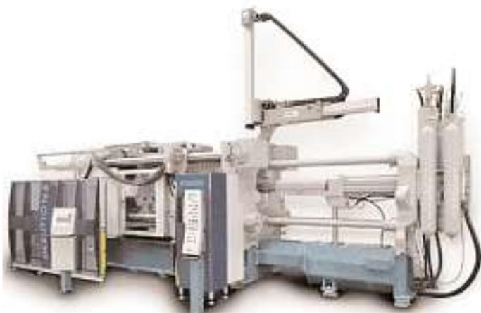
Bild 1: Kaltkammer-Druckgießmaschine, Typ Vision B mit „Dat@net“-Steuerung.
