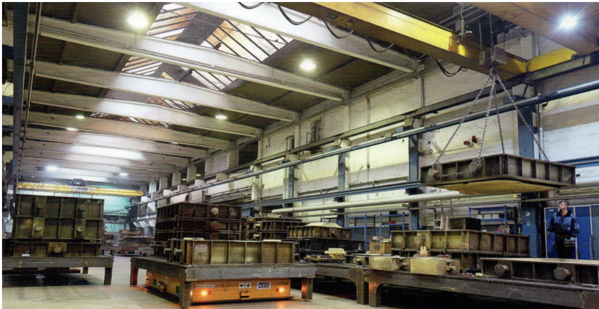
Abb. 4: Automatisches Logistiksystem in einer Handform- gießerei [7]
