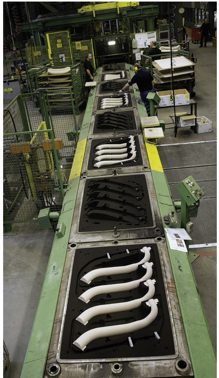
Abb. 8: MGG gießt auch im Niederdruck-Sandgussverfahren, mit dem besonders dünnwandige Teile produziert werden können.
