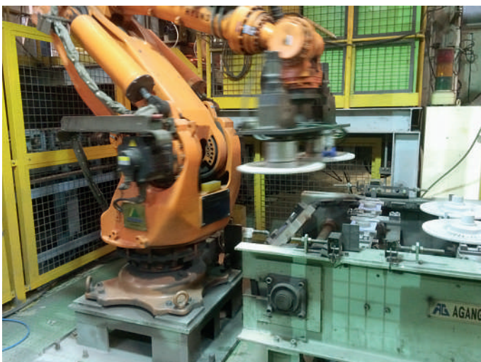
Abb. 5: Kerneinlegeroboter an DISAMATIC
