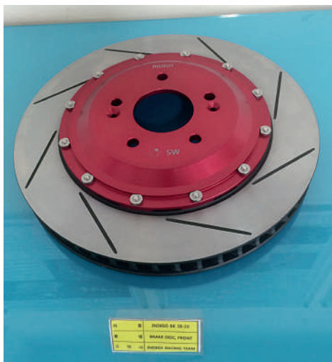
Abb. 9 und 10: Bearbeitete Bremsscheiben der Gießerei Hyundai Sungwoo
