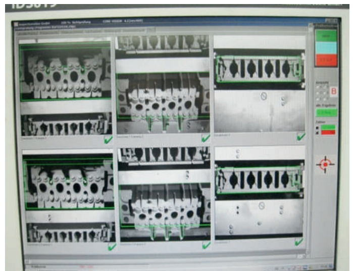
Abb. 17: Monitorbild der Vollständigkeitskontrolle der Kernkorrekturen mit i.O.-Befund
