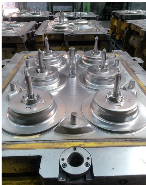
Abb. 8 (rechts): Modellplatte der kastengebundenen Formanlage
