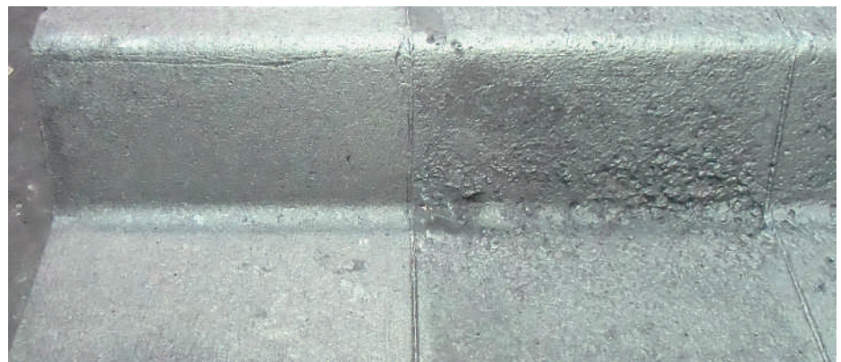
Abb. 1 (links: mit Imprägnierschlichte behandelt; rechts: herkömmliche Fertigung)
