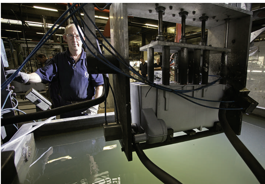
Abb. 3: Bei der Dichtigkeitsprüfung werden die Gussstücke auf mögliche Gasfehler und Schrumpfporositäten geprüft. Speziell in der Produktion der Heizkessel konnte mit ECOCURE SL der Ausschuss aufgrund von Gasfehlern um über 5 % reduziert werden.
