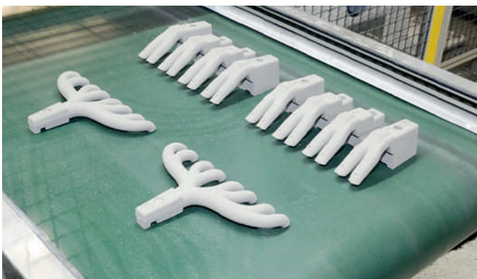
Abb. 10: Ein- und Auslasskanalkerne
