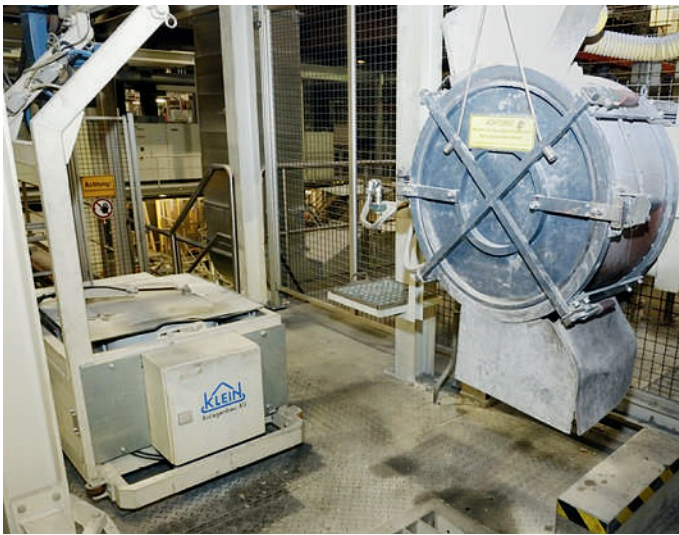
Abb. 8: Transportwagen links nach Befüllen aus Mischertrommel rechts
