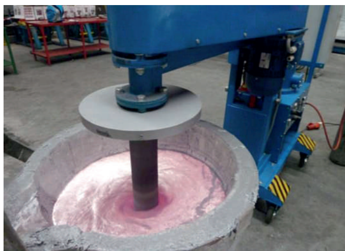
Abb. 8: Der HA Rotorject im Einsatz
