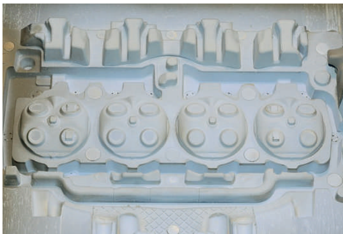
Abb.23: Grundplatte einer Serienkokille nach 6 Stunden Betriebszeit
