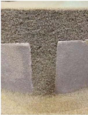
Abb. 3 a: ungeschlichtete Partien grob verrieben
