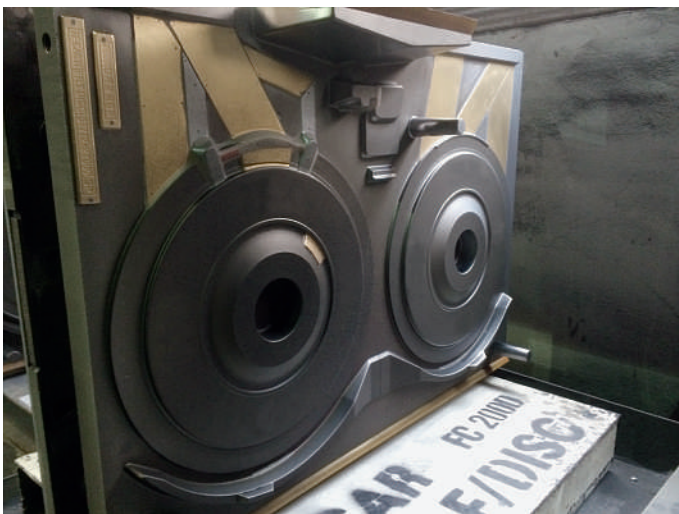
Abb. 4: Modellplatte einer DISA 240-C
