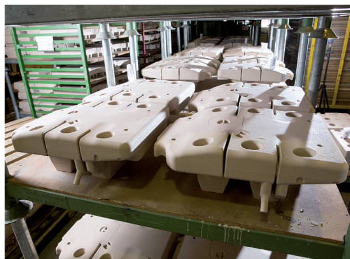
Abb. 6: Die Zugabemenge von Teil 2 kann mit dem neuen ECOCURE SL-System um mehr als 20 % reduziert werden. Dosiermengen des Wettbewerbsproduktes: Teil 1: 0,52 % und Teil 2: 0,52 %; Dosiermengen des ECOCURE SL-Systems: Teil 1: 0,53 % und Teil 2: 0,40 %.
