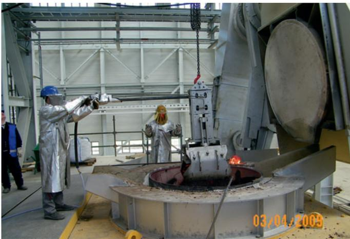
Bild 4 : Entfernen der Schlacke an einem 40-t-Tiegelofen
