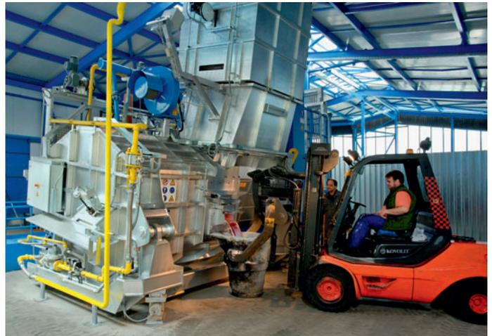
Bild 2: Beim Leistungstest wird ein Energieverbrauch von 525 kWh/t erzielt
