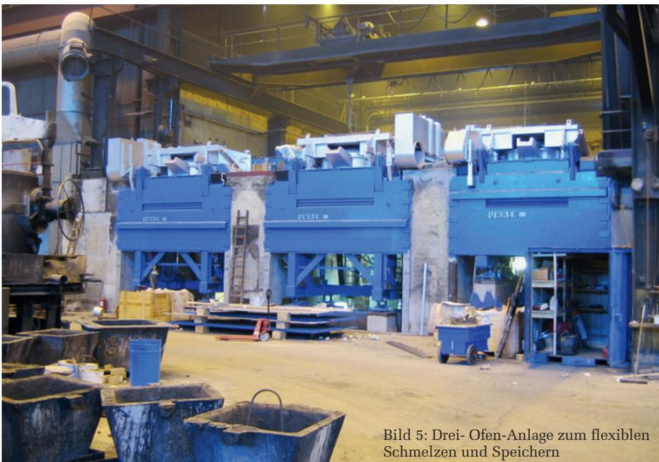
Bild 5: Drei-Ofen-Anlage zum flexiblen Schmelzen und Speichern
