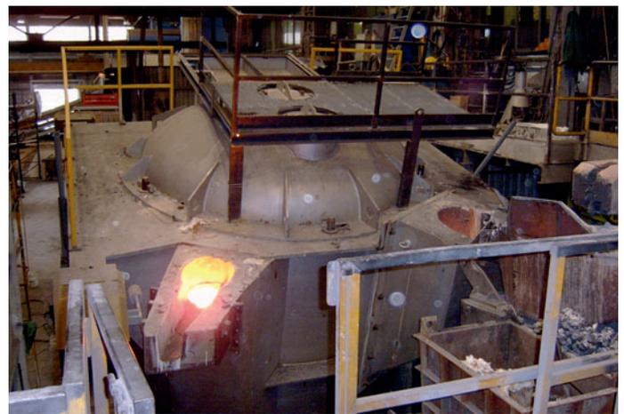
Bild 6: Ein- und Ausgussiphon einer 95-t-Rinnenofenanlage
