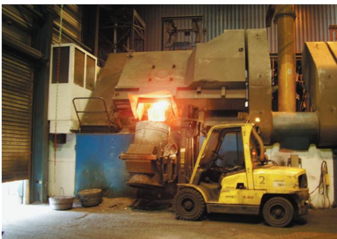
Bild 1: Ofenentstaubung bei der EWM Eisenwerk Martinlamnitz GmbH
