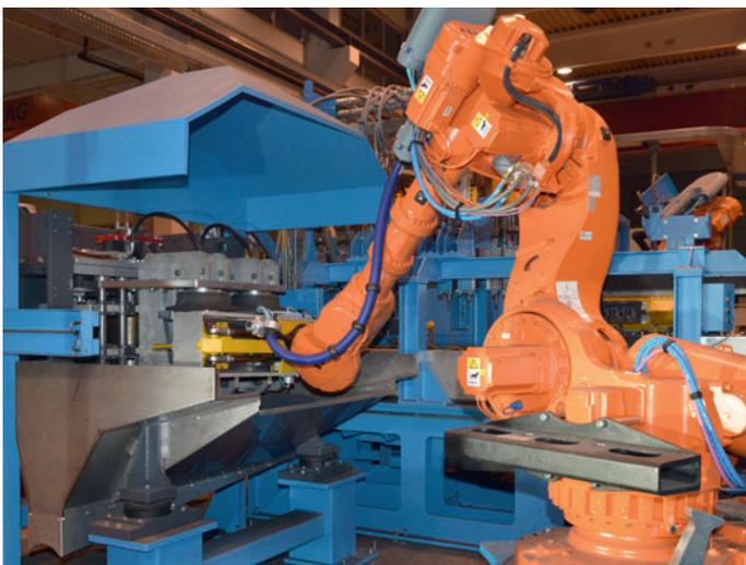
Bild 5: Roboter beim Entnehmen aus dem *twistmaster*
