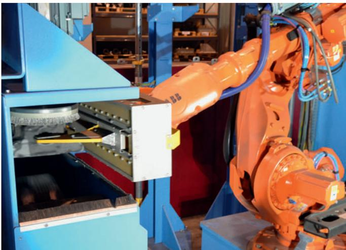
Bild 1: Roboter mit Teil in Bürst- und Schlagstation
