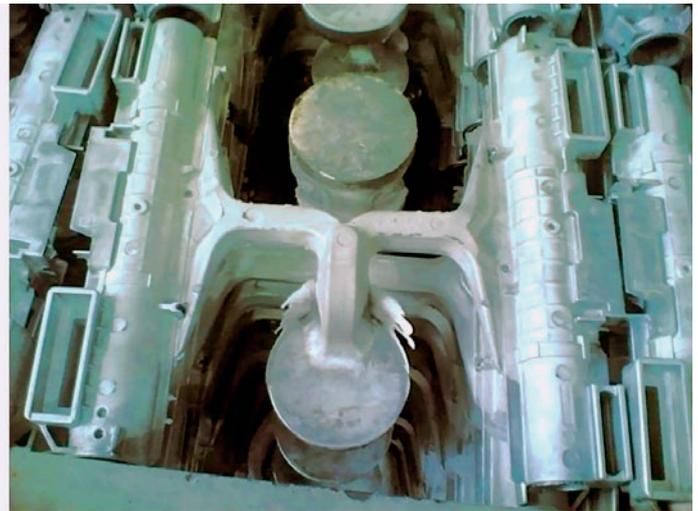
Bild 2: links: Magnesiumbauteil, gegossen auf einer Bühler Evolution 120 D; rechts: gleiches Teil mit gleichem Werkzeug, gegossen auf einer Carat 130 compact mit deutlich reduzierter Flitterbildung
