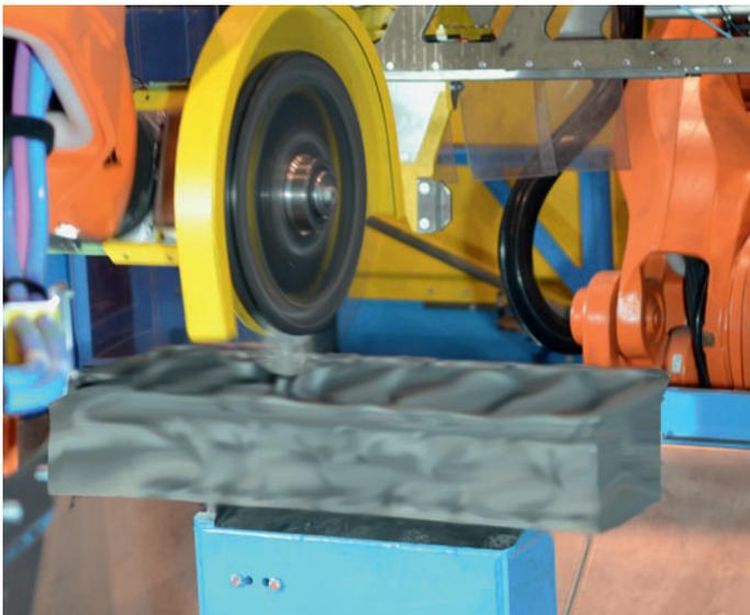
Bild 4: Abschlagrad beim Entgratvorgang
