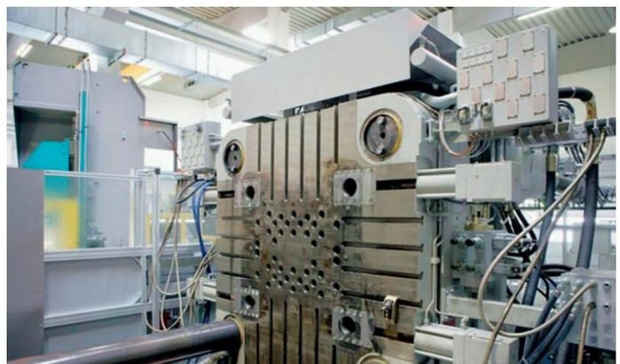
Bild 4: bei Carat-Maschinen lassen sich die Säulen vollständig zurückziehen und ermöglichen einen schnellen und sichereren Formwechsel.
