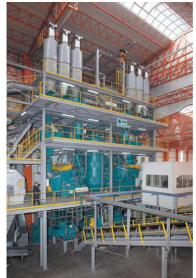
**Bild 1:** Moderner Mischer RV32VAC zur umweltfreundlichen und kostengünstigen Aufbereitung von Gießereiformsanden nach dem Evactherm®-Verfahren
