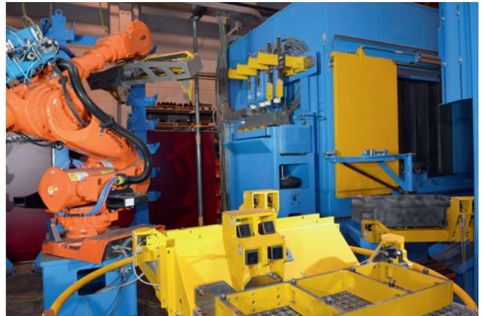
Bild 2: Roboter mit Hammerstation
