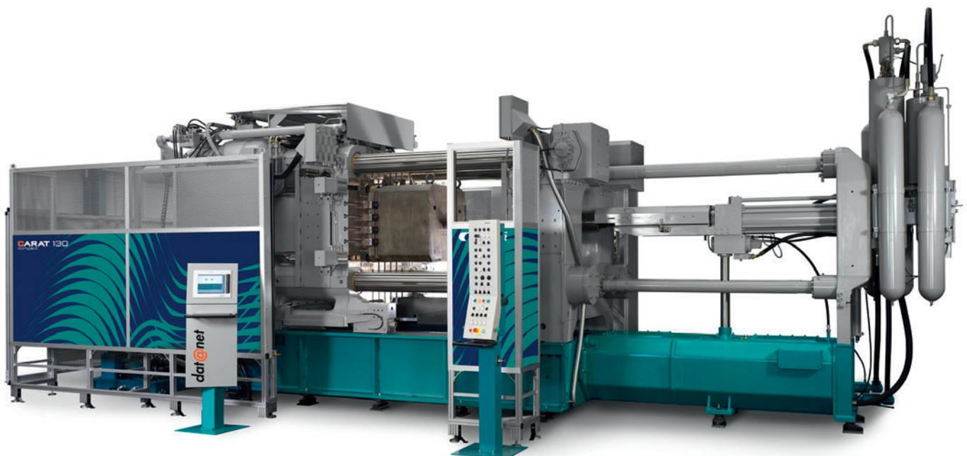
Bild 1: Die Carat Zweiplatten-Druckgießmaschine von Bühler
