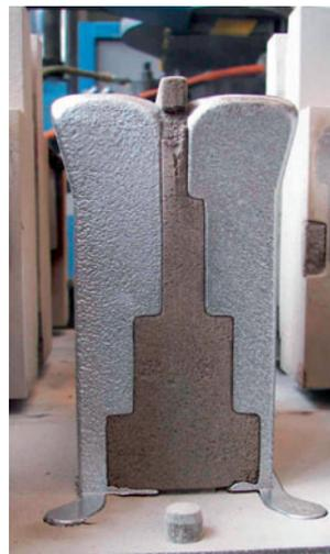
nungskurven ident. Auch im plastischen Bereich verlaufen die Kurven deckungsgleich bis zum Bruch der Probe aus dem Abguss mit eingelegtem INOTEC-Kern. Aufgrund der niedrigeren Porosität erreicht die INOTEC-Probe jedoch eine signifikant höhere Bruchdehnung und damit einhergehend mit der ansteigenden Kaltverfestigung auch eine höhere Zugfestigkeit.
