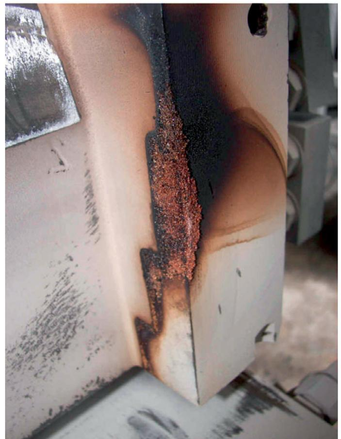
Bild 15: Starke Verharzung durch organische Kondensatbildung an der Kokillenflanke nach 10 Abgüssen mit Coldbox-Kernen
