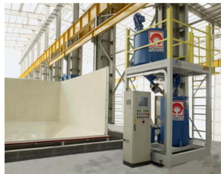
CPP Schlichte-Kontrollapparatur – Coatings-Preparation Plant von Foseco
