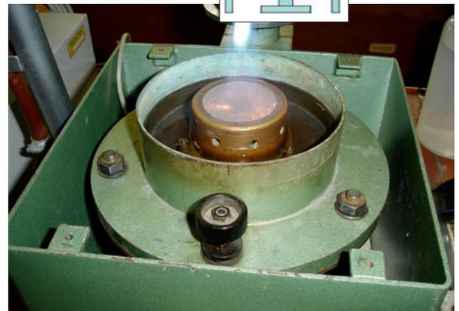
Abb. 7: Messung der Druckspannung einer Formsandschale während der Aufheizung. Das Fehlen von GKB erhöht in geringem Maße die Spannung, messbar anhand des Sensors unterhalb der Sandschale.
