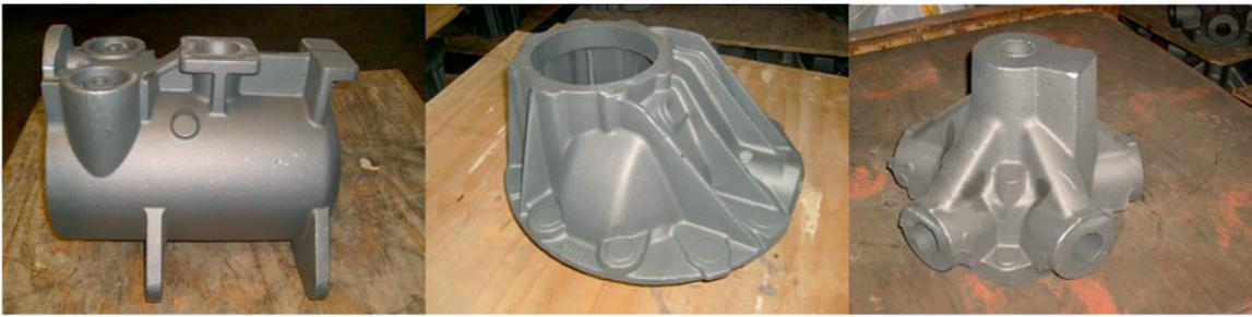
Abb. 9: Typische Gussteile, produziert in ENVIBOND®-haltigem Formsand
