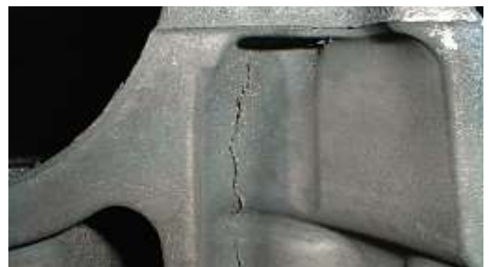
Bild 8 a: Penetration und Blattrippen innerhalb der Gussinnenfläche – ungeschlichtete Kerne und Wettbewerberadditiv
