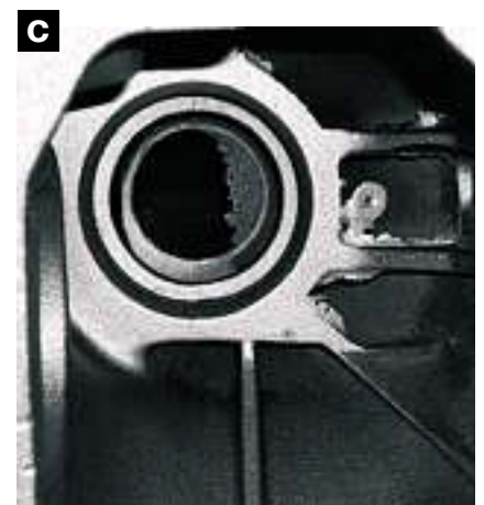
Bild 5: Beispiele für schlichtefreies Gießen: a) und b) Differentialgehäuse, jeweils mit 0,7 % CB je Teil, 7 % Additiv BR 14000; c) Hinterachsgehäuse, 0,7 % CB je Teil, 7 % Additiv BR 14000
