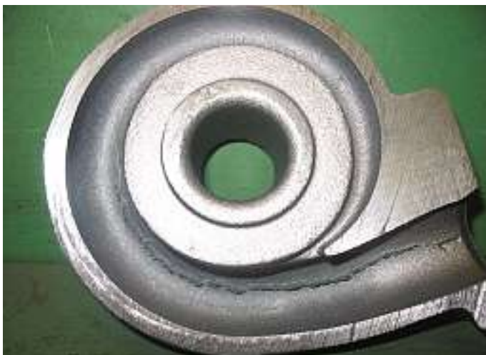
Bild 1: Große Blattrippe innerhalb eines PKW-Turboladergehäuses
