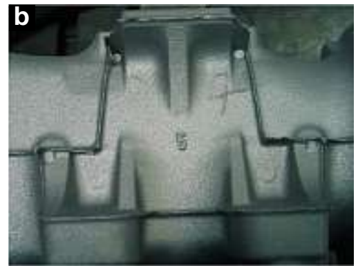
Bild 6: Vergleich geschichtet – ungeschichtet: a) Gussteil des (alkohol-) geschichteten Achsaußenkerns, 0,8 % CB je Teil; b) Gussteil des ungeschichteten Kerns, 0,8 % CB je Teil, 2,0 % Additiv BR 4048
