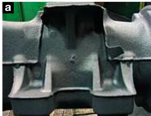
Bild 6: Vergleich geschichtet – ungeschichtet: a) Gussteil des (alkohol-) geschichteten Achsaußenkerns, 0,8 % CB je Teil; b) Gussteil des ungeschichteten Kerns, 0,8 % CB je Teil, 2,0 % Additiv BR 4048
