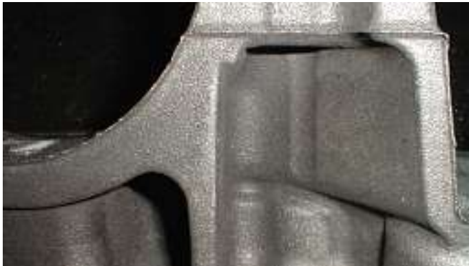
Bild 8 b: Fehlerfreie Gussteile mit ungegeschichteten Kernen und NORACEL W 100
