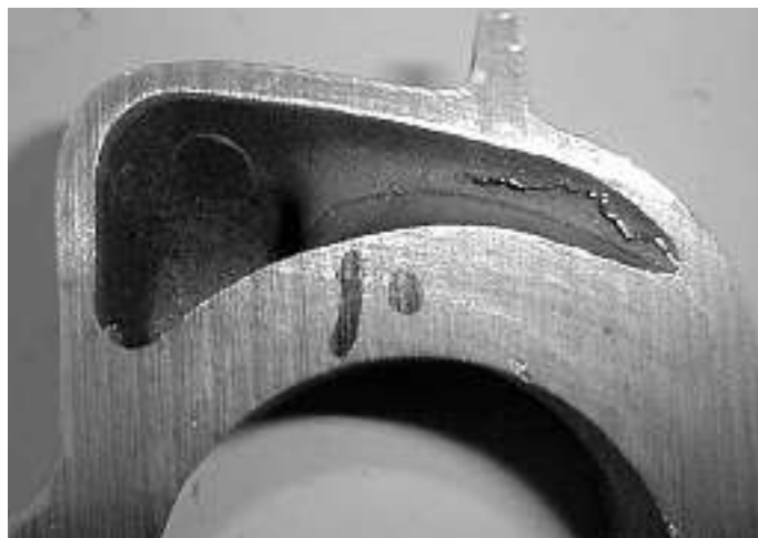
Bild 6a: Blattrippen in einem Hinterachsgehäuse trotz Einsatz von 2,9 Masse-% eines konventionellen Additivs
