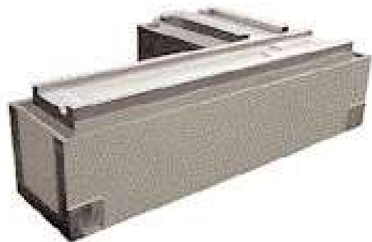
Abb. 3: Zweiteiliges Maschinenbett mit innenbelassenem Kernsand, fertig bearbeitet und montiert.
