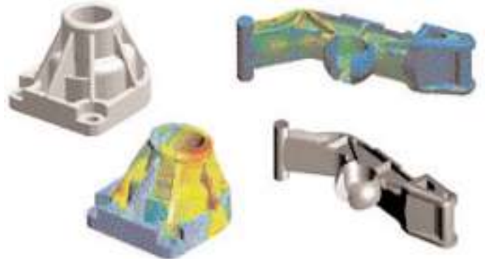
Bild 1: Spiegelhalter und Pumpengehäuse als CAD-Geometrie und vernetzte FEM-Geometrie unter mechanischer Belastung ( http://www.fem.ch/index.htm vom 29.1.2004).
