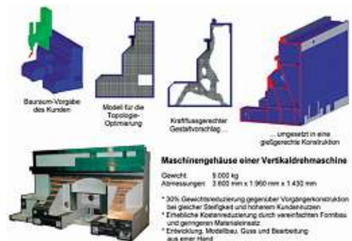
Bild 12: Topologieoptimiertes Drehmaschinenbett (Optimierungssoftware: SKO).
