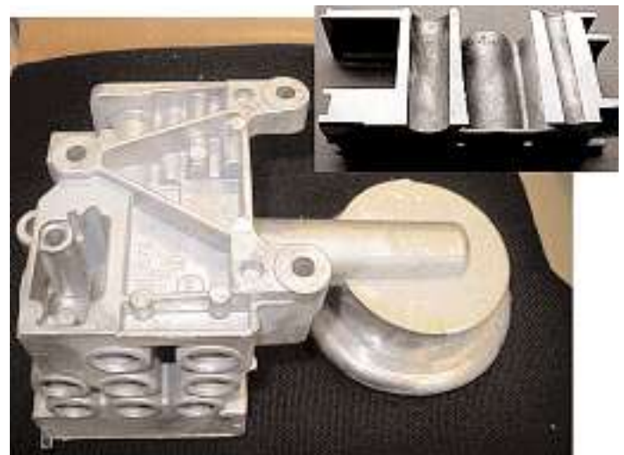
Bild 10: Einer der ersten Abgüsse des umkonstruierten Ventilgehäuses; dieses zeigt keine Porosität.
