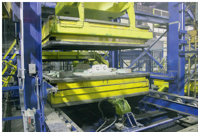
Abb. 6: Zulegestation (Oberkasten wird auf den Unterkasten abgesenkt)
