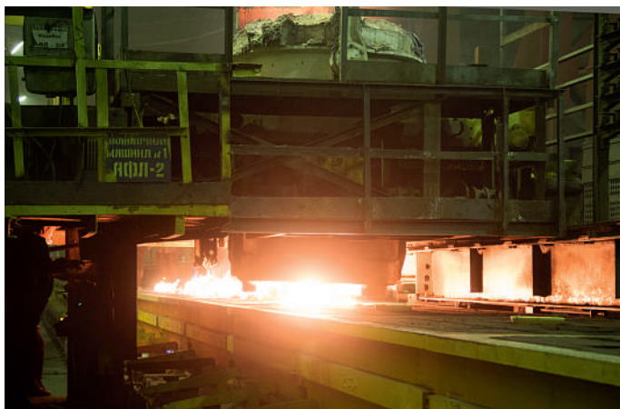
Abb. 4: Abguss mittels Stopfenpfanne
