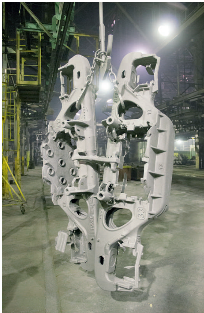
Abb. 7: Gussstücke nach dem Strahlen
