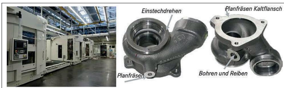
Abb. 18: Serienbearbeitung der Turbinengehäuse M271.
