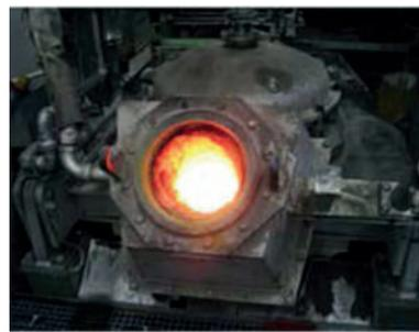
Abb. 17: Niederdruckgießen der Prototypen, Ofen.
