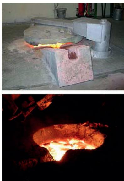
Abb. 14: Schmelzprozess im Induktionsofen.
