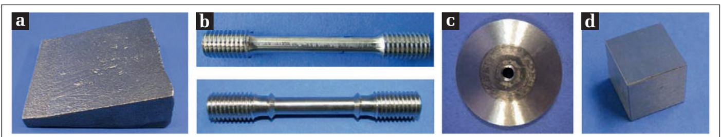
Abb. 8: Werkstoff-Proben: a) Y-Block, b) Zug-, Kriechprobe, c) TMF-Scheibe, d) Oxidationswürfel.
