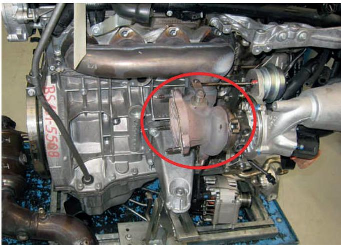
Abb. 2: Turbolader-Turbinengehäuse am Ottomotor M271evo.
