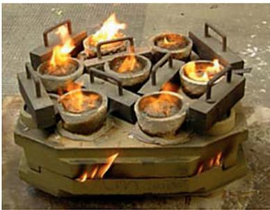
Abb. 16: Durch Schwerkraftgießen hergestellte Prototypen von Turbinengehäusen.
