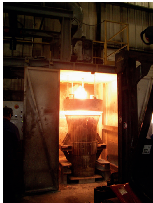
Bild 5: Drahtbehandlungsstation für die Herstellung von GJV
