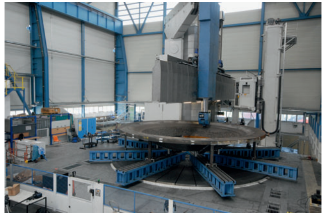
Mechanische Bearbeitung eines Mühlenbodens
