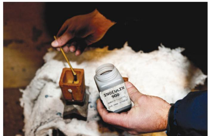
Abb. 9: Einfüllen von Impfmittel in den Tiegel
