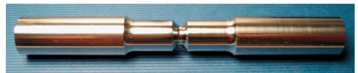
Abb. 13: Rundprobe zur Bestimmung des Einflusses des Festwalzens auf die Schwingfestigkeit.
