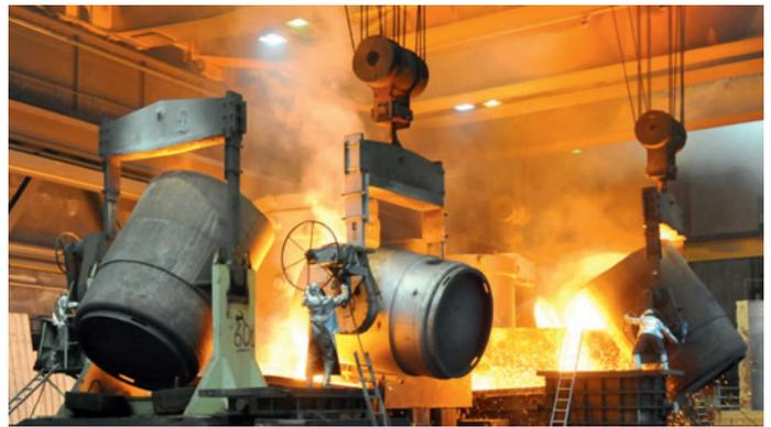
Bild 4: Abguss von 283 t Schmelze gleichzeitig aus 5 Pfannen
