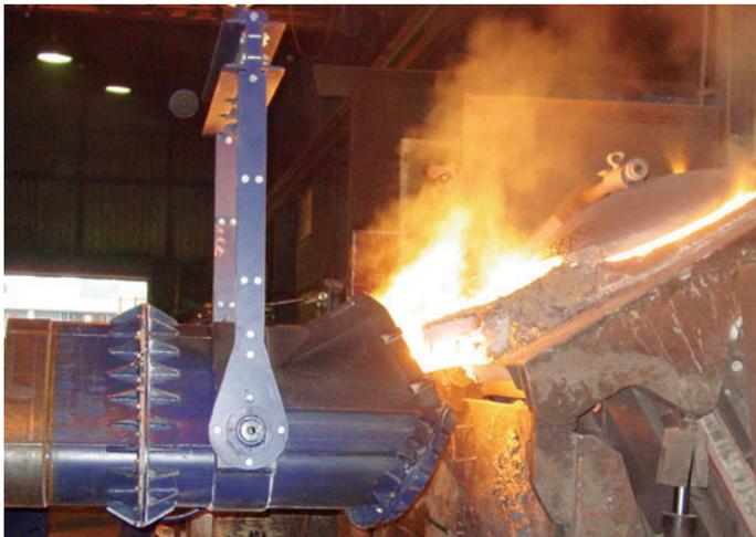
Bild 6: 700 kg-Konverter im Betrieb (Fallstudie 1)
