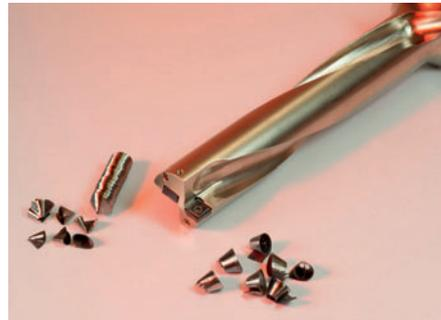
Bild 2: Bohrerdesign und Spanraumgestaltung des neuen Vollbohrwerkzeugs MaxiDrill 900 5xD garantieren geringe Schnittkräfte, optimalen Abtransport der Späne und maximale Systemsteifigkeit für präzises und wirtschaftliches Bohren.
