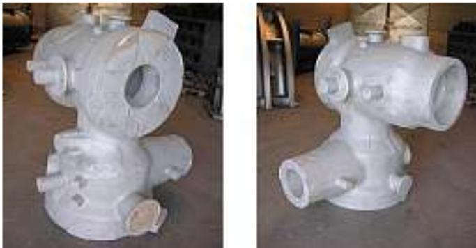
Abb. 15: Pilotventil nach Entfernung der Gusstechnik im gestrahlten Zustand
