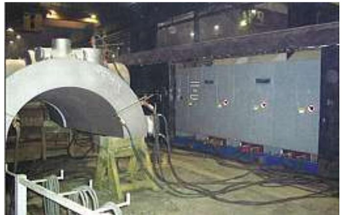
Bild 4: Multi-Direktional Magnetisierungs-Anlage
