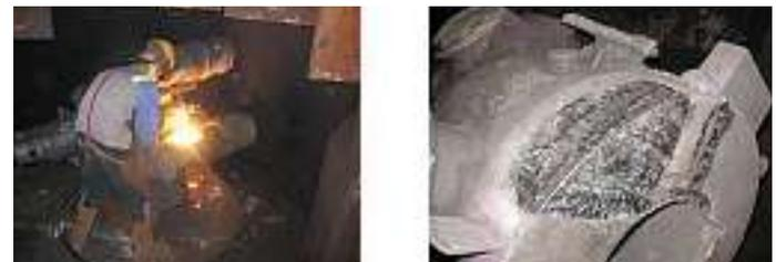
Abb. 13: Speiserabtrennen (links) und von Speisern befreites Pilotventil (rechts)
