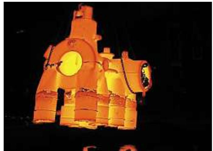
Abb. 12: Lösungsgeglühtes Pilotventil beim Umsetzen vom Ofen ins Wasserbecken (Transferzeit 24 sec.)
