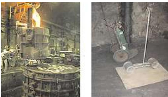
Abb. 11: Pfannenpositionierung vor Abgussbeginn (links) und Vorrichtung zum Gießstrahlschutz (rechts)
