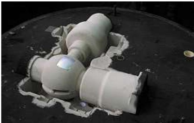
Abb. 10: Zugestellter Formunterkasten mit eingelegtem Kern
