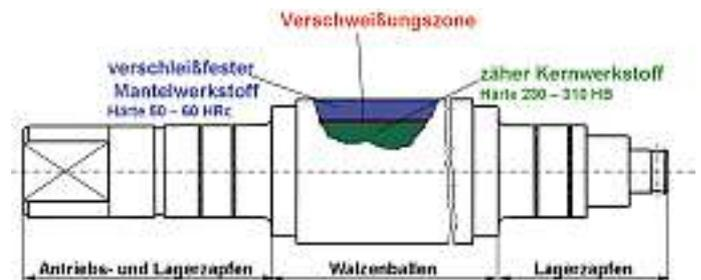
Abb. 1: Schematische Darstellung einer Arbeitswalze (Verbundguss) für Warmbreitband
