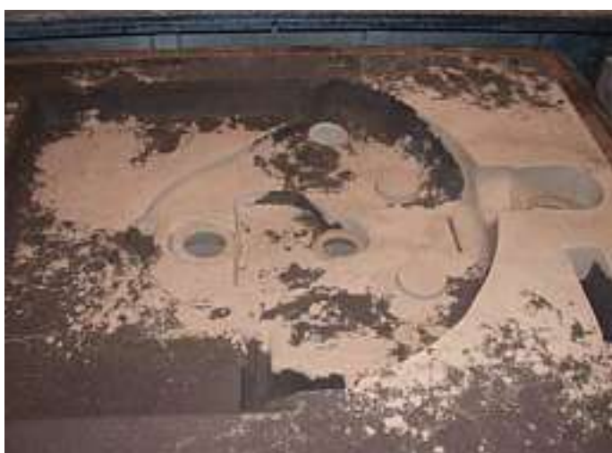
Bild 5: Oberkasten Formhälfte des inneren Radkastens
