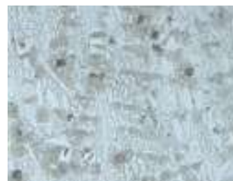
c) ~ 0.7% Cu, schnelle Erstarrung ~ 0.7% Cu, rapid solidification
