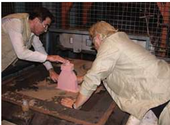
Bild 4: Formherstellung des inneren Radkastens
