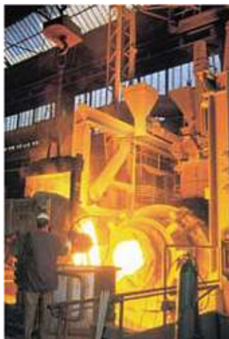
Bild 8: VARP- Konverter beim Füllen
