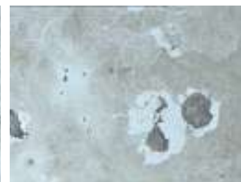
d) ~ 0.7% Cu, langsame Erstarrung ~ 0.7% Cu slow solidification
