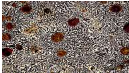
Bild 1.: Typisches Aussehen eines normalen ADI Werkstoffes Typical structure of a common ADI material
