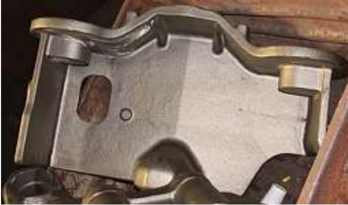
Bild 9: Blick auf die Innenseite eines äußeren Radkastens
