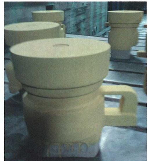
Bild 5: Oberfläche eines mit „Hydro A 70“ geschichteten und getrockneten Kernes (Achsgehäuse)
