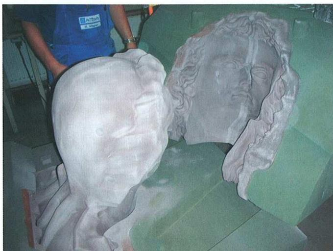
Abbildung 10: Kombination aus Laser-gesintertem (braun) und im Direkten Formstoff-Fräsen hergestelltem Formteil (grün)
