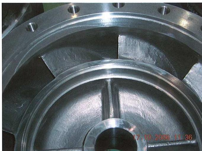
Abbildung 5: Schaufel-Detail
