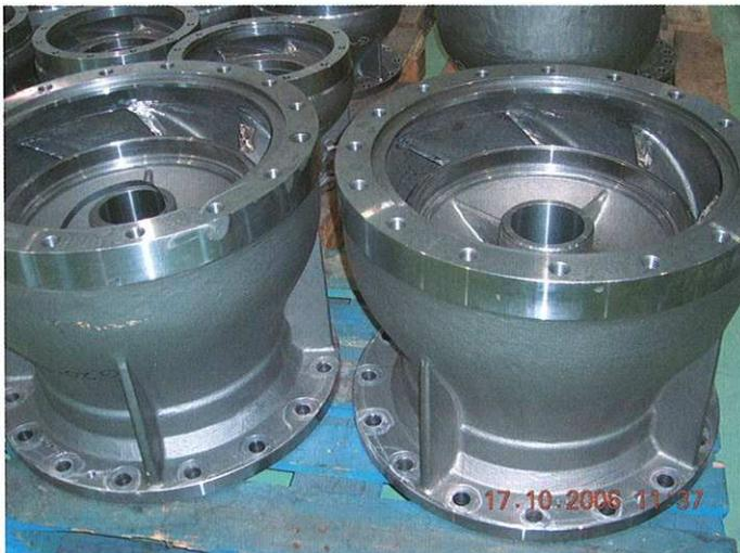
Abbildung 4: Abguss Pumpengehäuse
