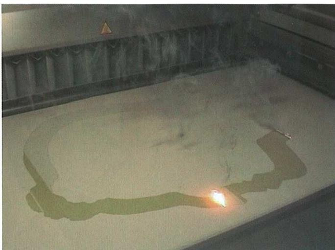
Abbildung 7: Laser-Sintern eines Formteils
