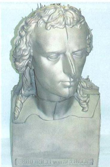
Abbildung 13: Das Rohgussteil (Gusskörpergewicht 240kg)
