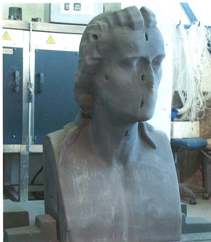
Abbildung 9: Im Direkten Formstoff-Fräsen hergestelltes Formteil
