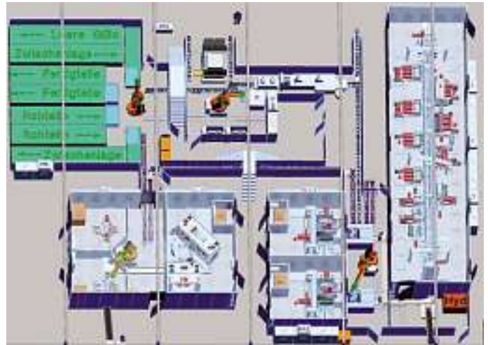
Layout Bearbeitungsanlage für BMW-Motorblock
