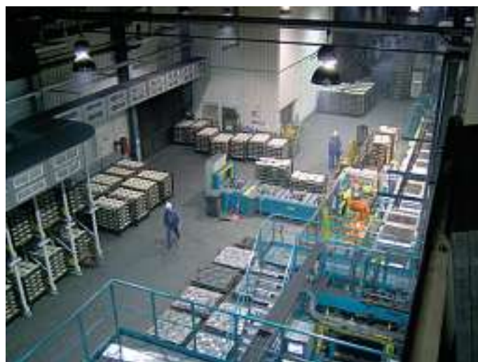
Bild 5: Blick auf die Unterkasten-Kerneinlegestation
