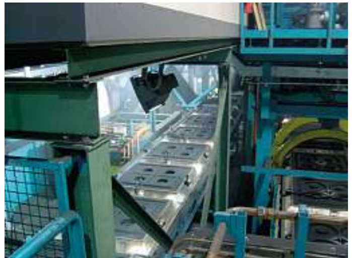
Bild 2: Blick auf die Oberkasten-Kerneinlegestrecke
