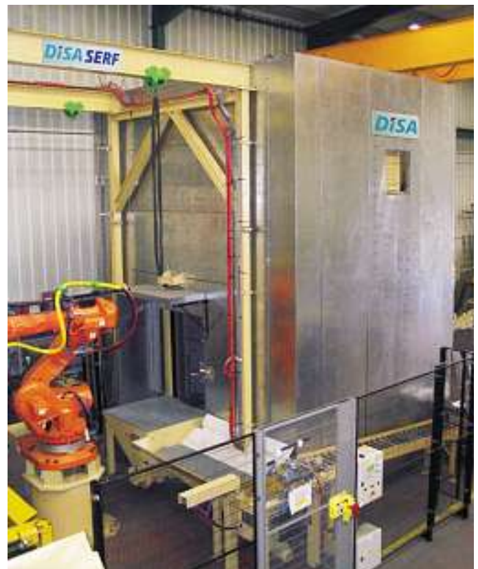
Bild 7: Strahlmaschine (Bauart DISA, Typ SPH3)
