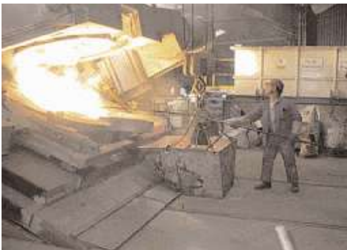
Bild 3: Tiegelofenanlage mit stufenloser Rückwärtskipfung
