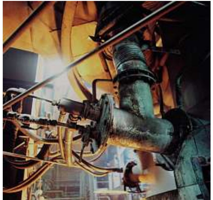
Bild 10: Moderne Erdgas-Sauerstoffbrenner ersetzen anteilig den Koks und tragen hierdurch zu einer Senkung der SO 2 -Emissionen bei.
