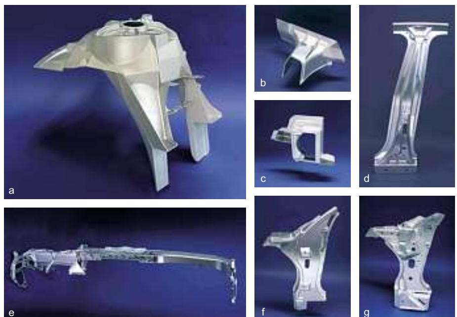
Bild 1: Strukturteile aus Aluminium- und Magnesium-Druckguss, a) Federbeinstütze, b) Schließteil für Längsträger-Knoten, c) Pralltopf hinten, d) B-Säule, e) Instrumententafelträger, f) A-Säule (Außenteil), g) A-Säule (Innenteil).
