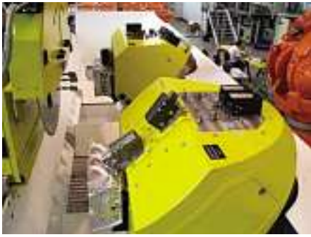
Sägeanlage der Rohgussbearbeitung für Zylinderköpfe bei Hydro Aluminium Mandl&Berger GmbH in Linz.
