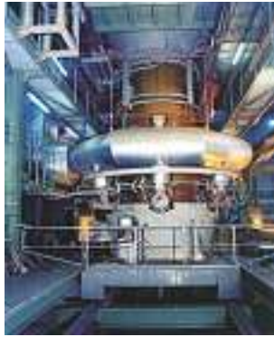
Bild 8: Die Staubeinbringung in die Kupolöfen durch Einblasen oder durch Brikett-Chargierung trägt wesentlich zur Minderung des Reststoffaufkommens bei.
