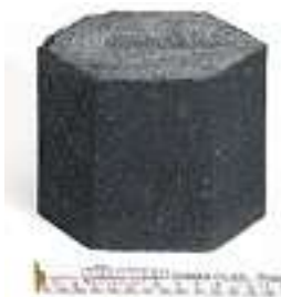
Bild 9: Durch neuentwickelte direktreduzierende Staubbriketts können auch oxidierte Stäube dem Metallkreislauf wieder zugeführt werden.
