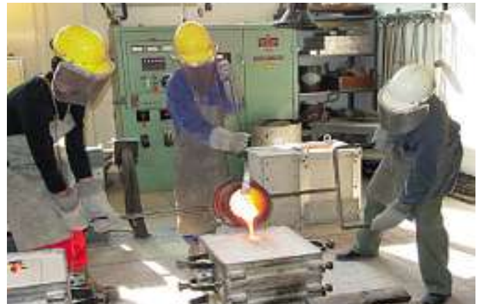
Bild 3: Das Gießen der eingeformten Teile.
