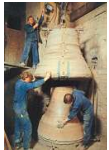
„Scheiden der Glockenform“
