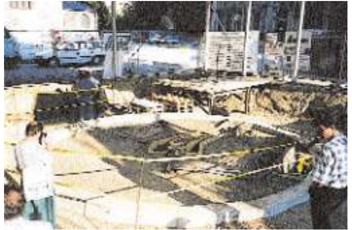
Bild 5: Die geschlossene Form der Domina vor dem Abguss.
