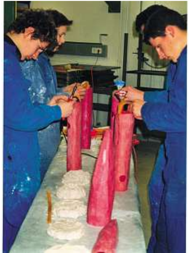
Bild 2: Bei den Wachsmodellen werden die Eingussysteme angebracht.
