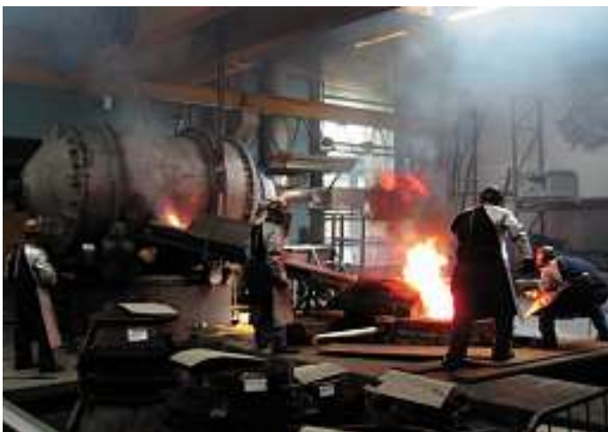
Guss „mit Rinnwerk
