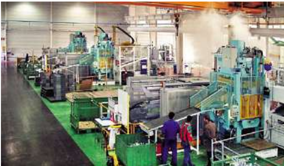
Die neue Gießerei in Saint-Claude fertigt Teile für den Automobilhersteller Peugeot – in diesem Teil der Gießerei haben fünf Bühler-Druckgießzellen Platz.
